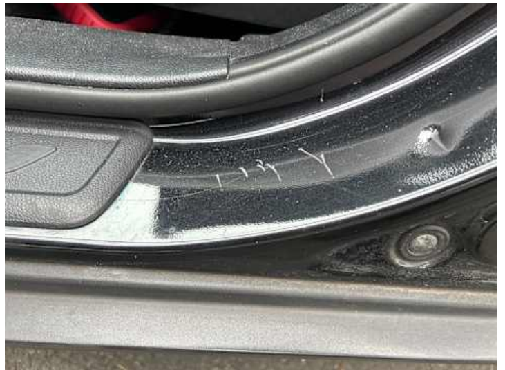
Schweller links (Lackschaden, Delle)
