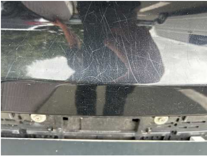
Heckklappe (Kratzer, Lackschaden)
