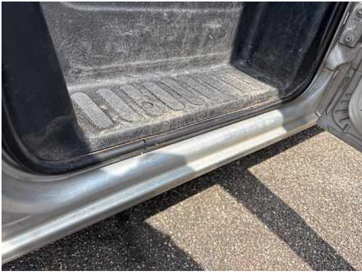
Schweller rechts (Lackschaden, Kratzer)
