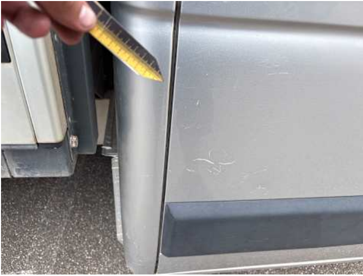
Türe hinten rechts (Lackschaden)
