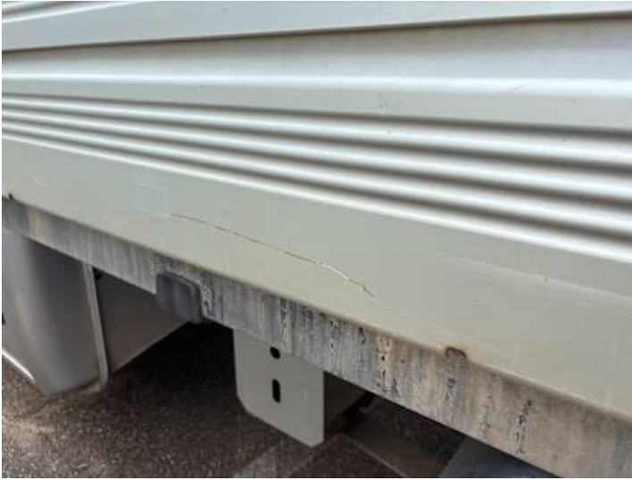
Seitenteil hinten links (Delle, Lackschaden, Kratzer)
