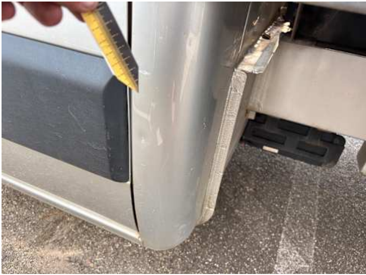
Seitenteil hinten links (Delle, Lackschaden, Kratzer)
