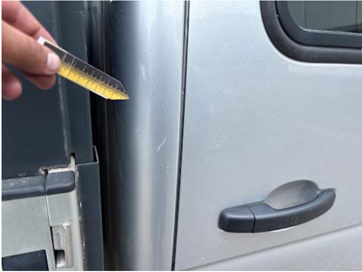
Türe hinten rechts (Lackschaden)
