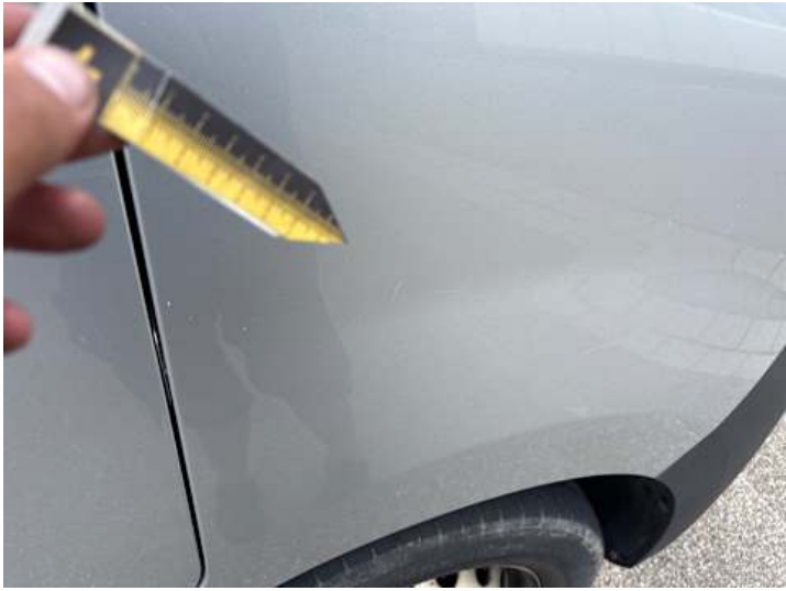
Kotflügel vorne rechts (Kratzer, Lackschaden)
