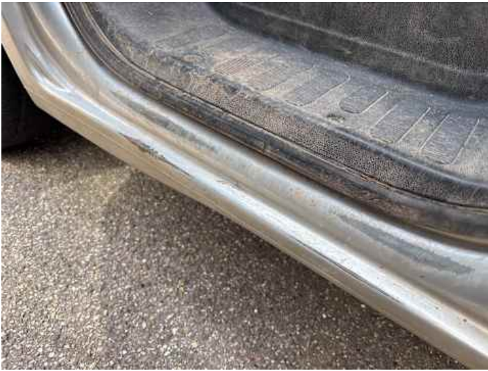
Schweller links (Lackschaden, Kratzer)
