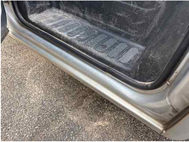
Schweller links (Lackschaden, Kratzer)
