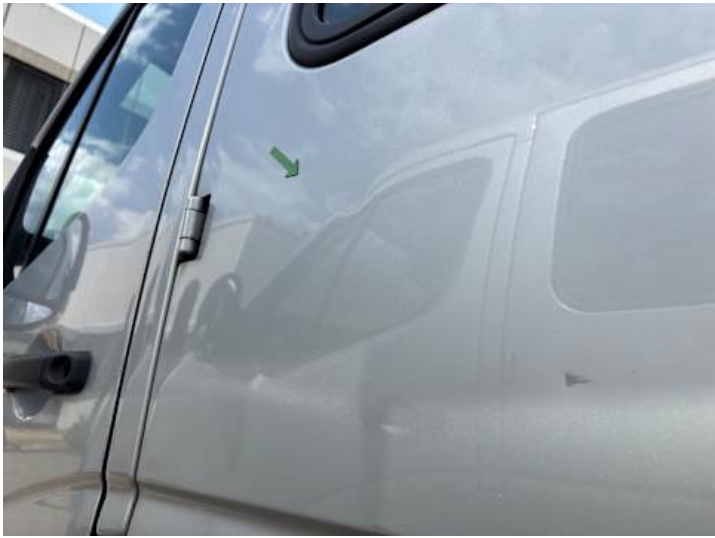
Türe hinten links (Delle)
