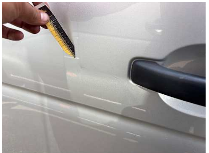
Türe hinten links (Lackschaden)
