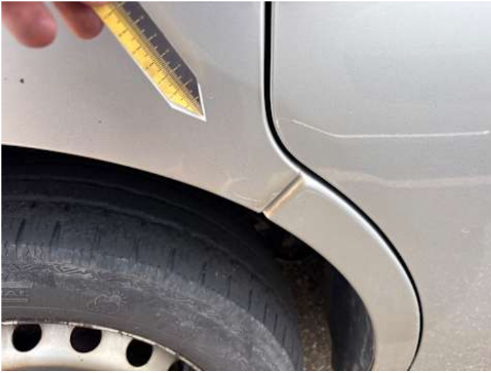
Kotflügel vorne links (Lackschaden)
