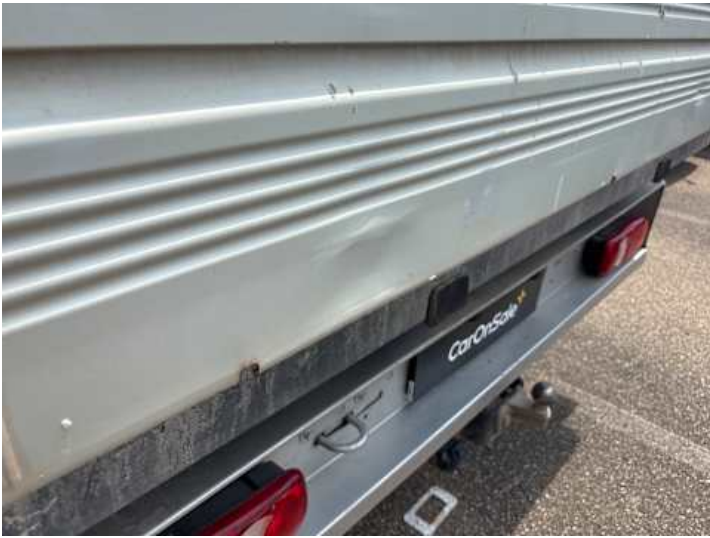
Heckklappe (Lackschaden, Delle)
