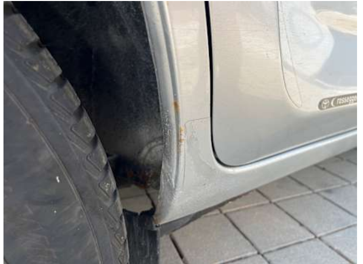
Seitenteil hinten rechts (Rost)
