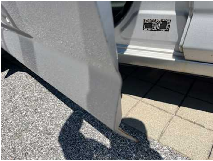
Fahrertür (Lackschaden, Rost)
