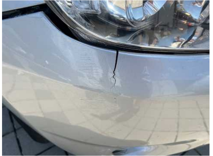
Stoßstange vorne (Riss/Bruch)
