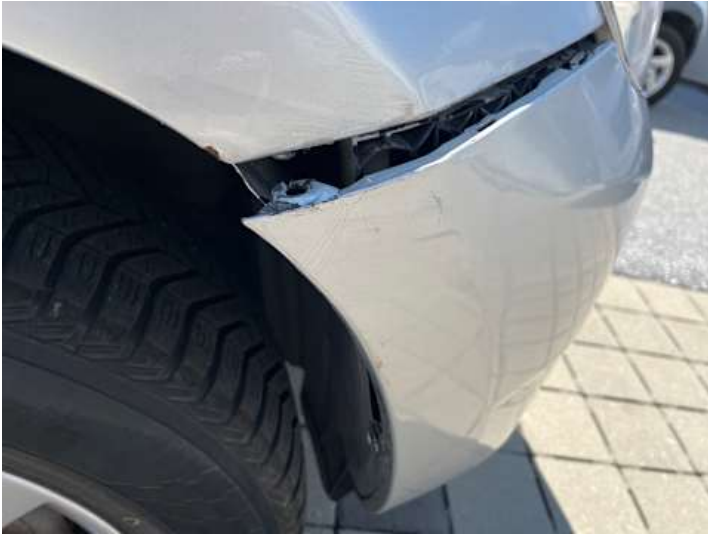
Stoßstange vorne (Riss/Bruch)
