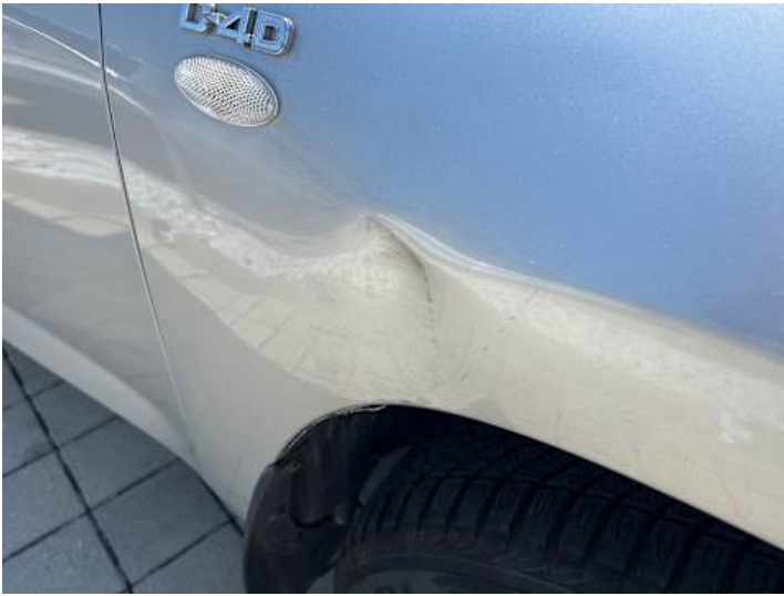
Kotflügel vorne rechts (Delle, Kratzer)
