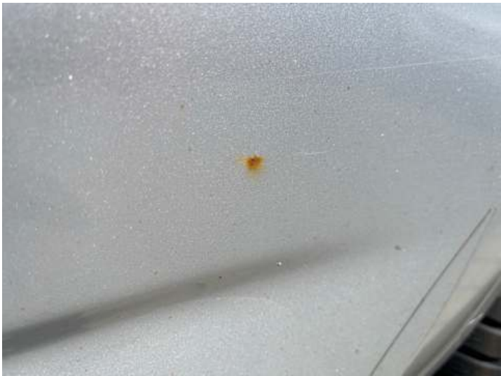
Türe hinten links (Rost)
