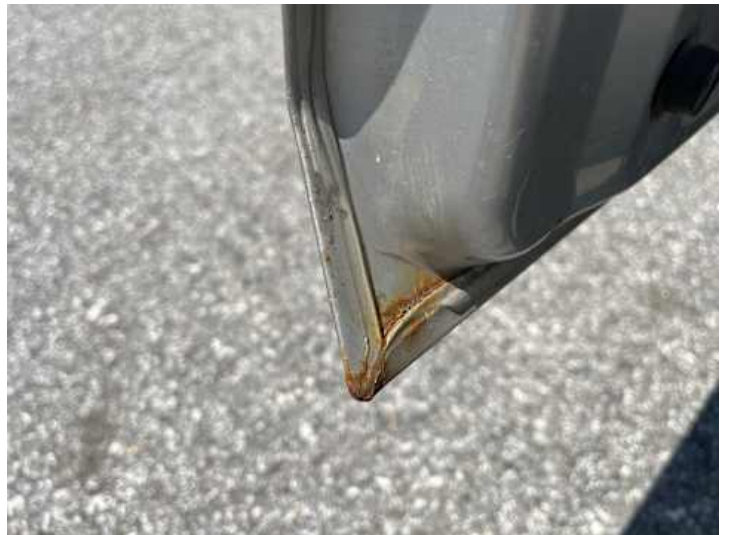
Fahrtür (Lackschaden, Rost)
