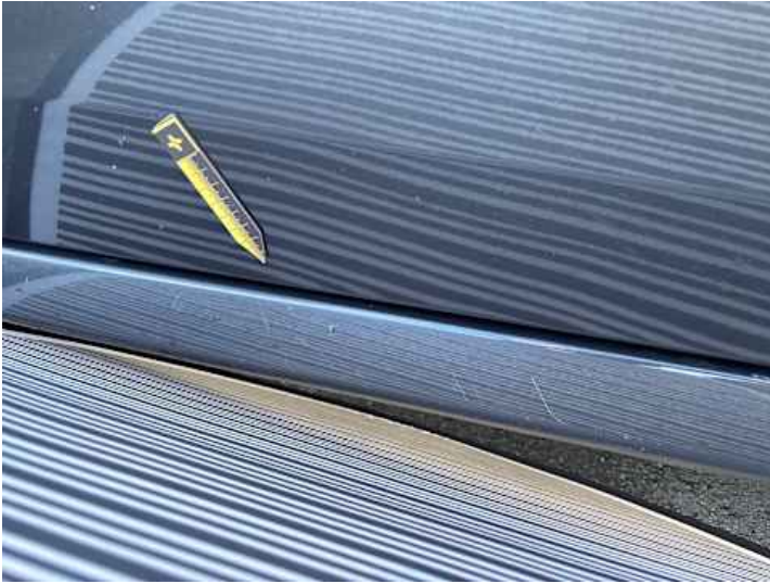
Schweller rechts (Lackschaden, Verformung)
