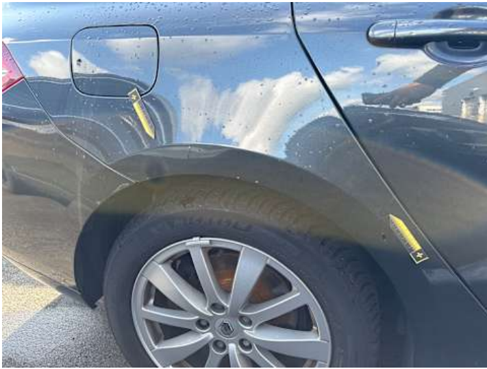
Seitenteil hinten rechts (Lackschaden, Verformung)
