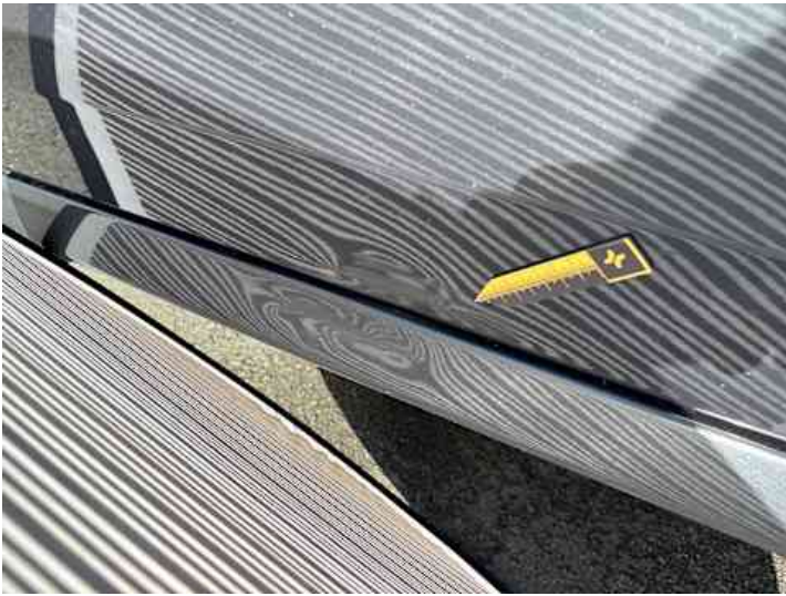
Schweller links (Verformung, Lackschaden)
