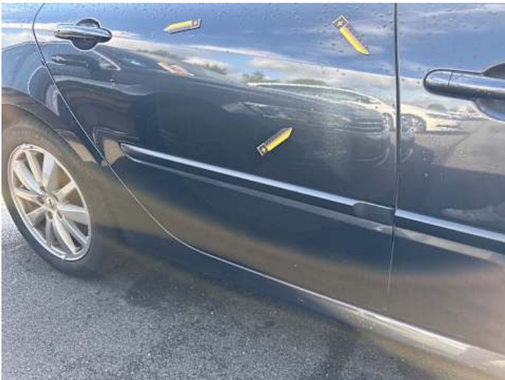
Türe hinten rechts (Delle, Kratzer, Lackschaden)
