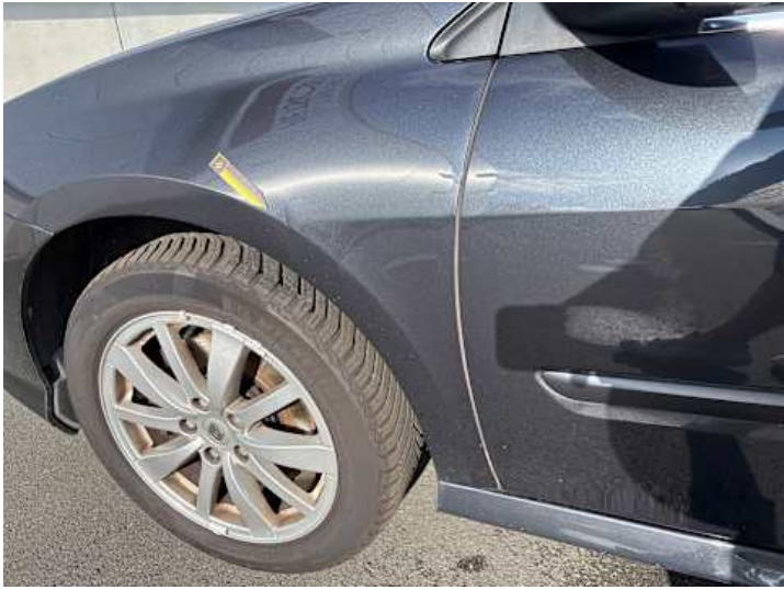
Kotflügel vorne links (Delle, Lackschaden)
