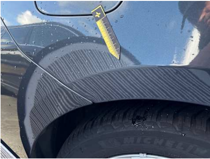
Seitenteil hinten rechts (Lackschaden, Verformung)
