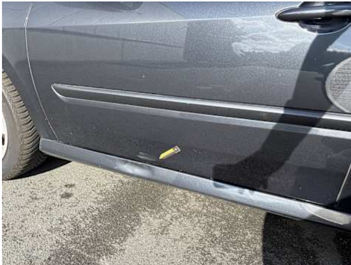
Fahrtür (Lackschaden, Verformung)
