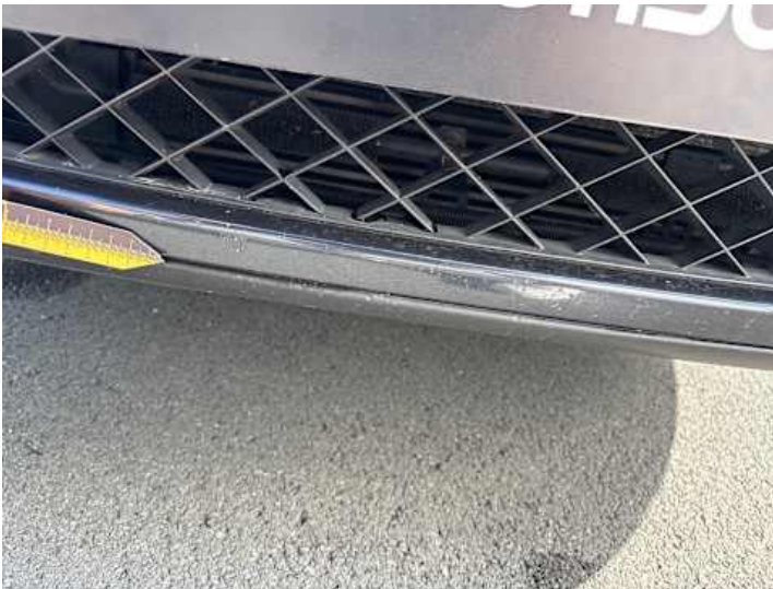
Stoßstange vorne (Lackschaden)
