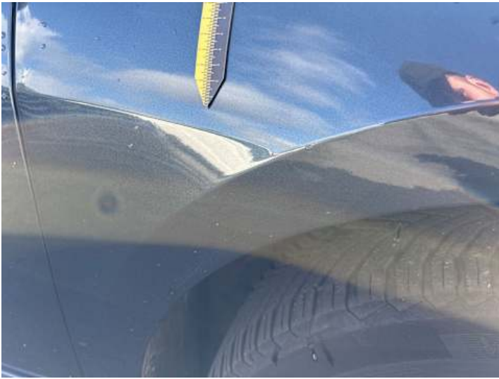
Kotflügel vorne rechts (Kratzer)
