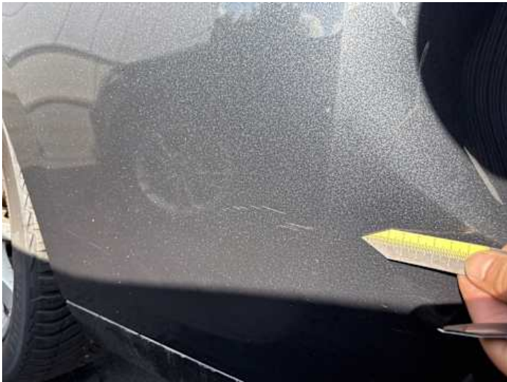
Stoßstange hinten (Kratzer, Lackschaden)
