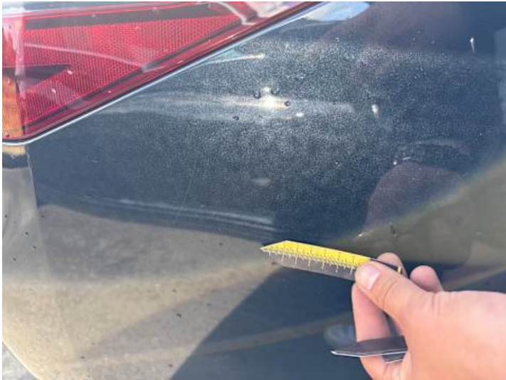
Stoßstange hinten (Kratzer, Lackschaden)
