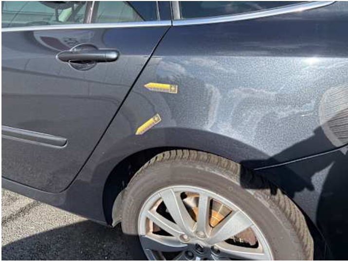
Seitenteil hinten links (Kratzer, Delle)
