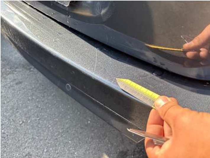
Stoßstange hinten (Kratzer, Lackschaden)
