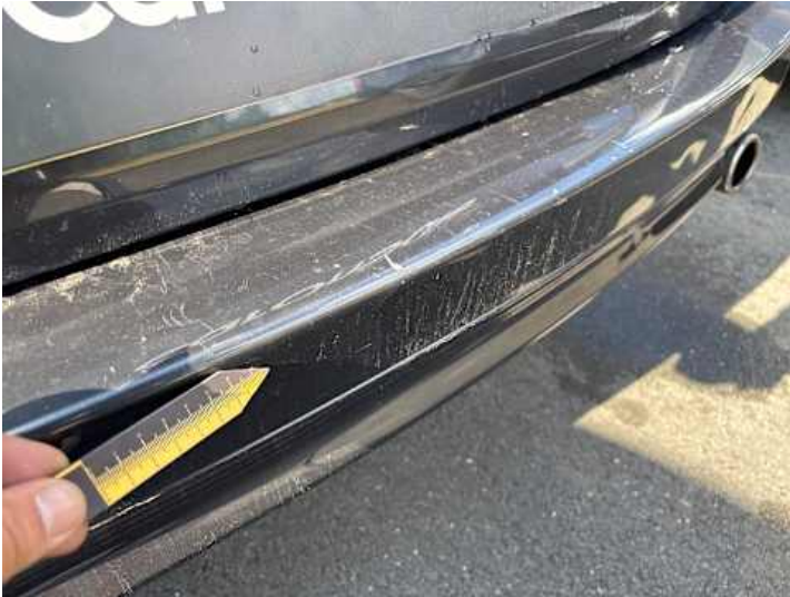
Stoßstange hinten (Kratzer, Lackschaden)
