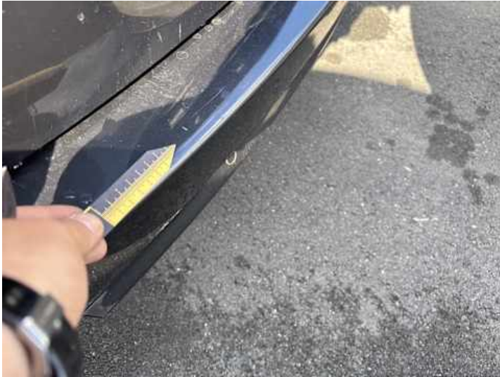
Stoßstange hinten (Kratzer, Lackschaden)
