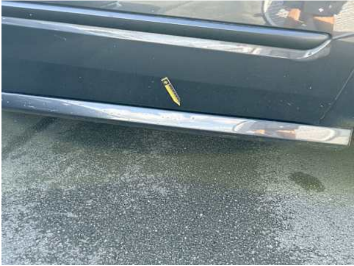
Schweller rechts (Lackschaden, Verformung)
