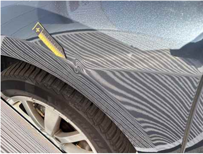
Kotflügel vorne links (Delle, Lackschaden)
