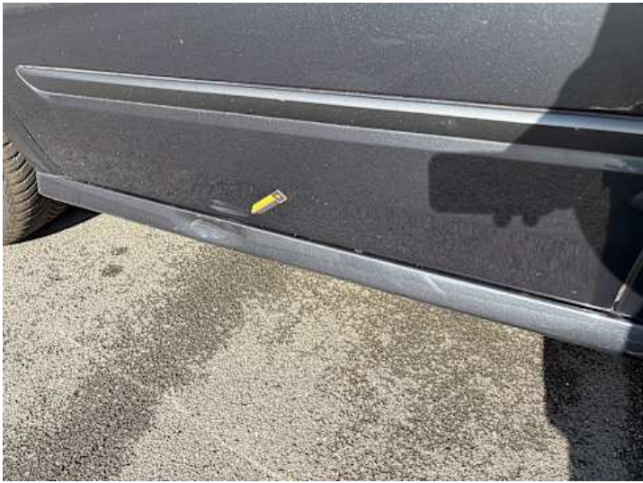
Schweller links (Verformung, Lackschaden)
