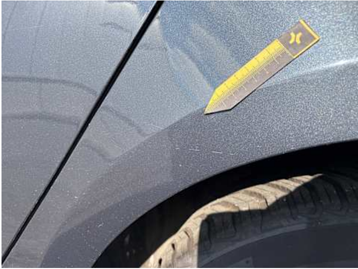
Seitenteil hinten links (Kratzer, Delle)
