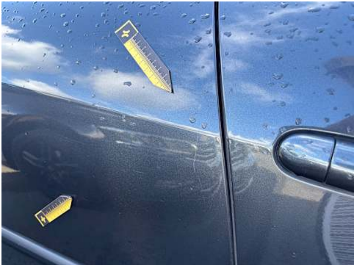
Türe hinten rechts (Delle, Kratzer, Lackschaden)
