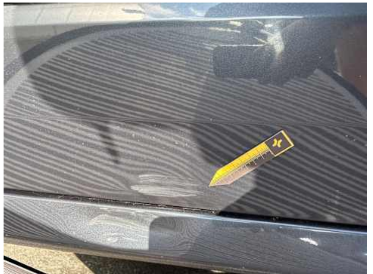
Fahrtür (Lackschaden, Verformung)
