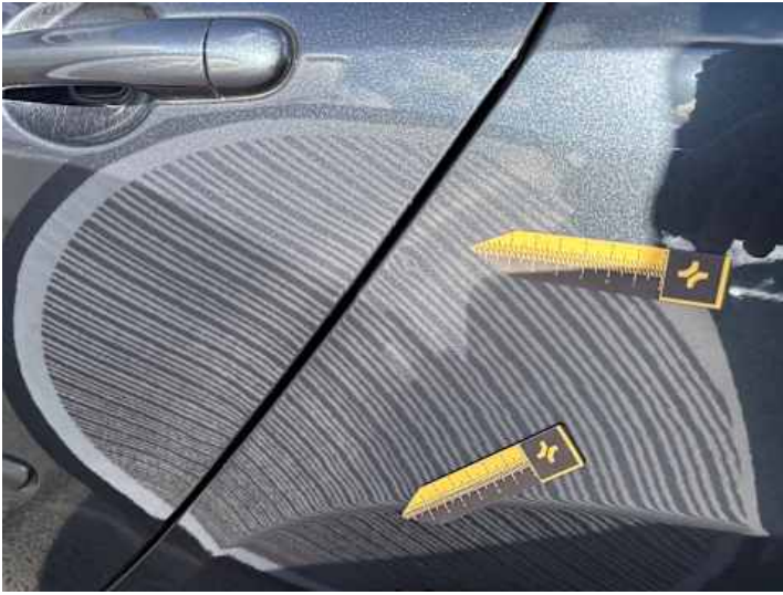
Seitenteil hinten links (Kratzer, Delle)
