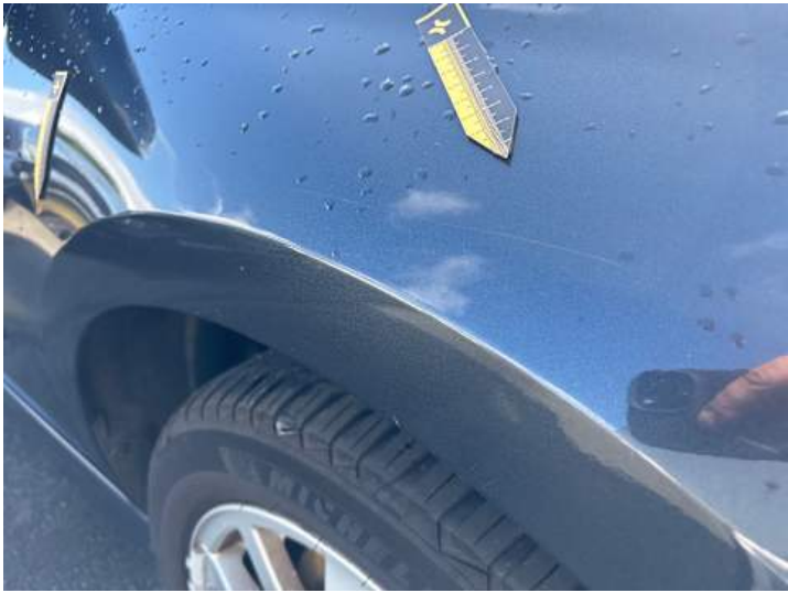
Kotflügel vorne rechts (Kratzer)
