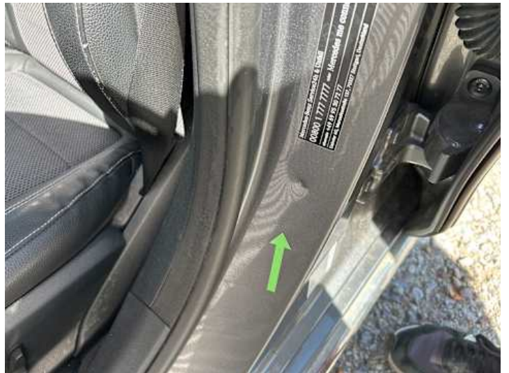
Schweller links (Delle, Kratzer)
