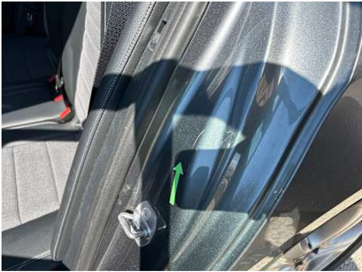
Schweller links (Kratzer)
