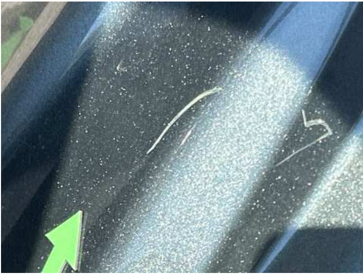
Schweller links (Kratzer)
