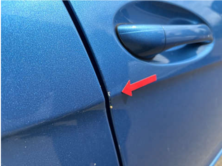
Beifahrertür (Lackschaden, Rost)
