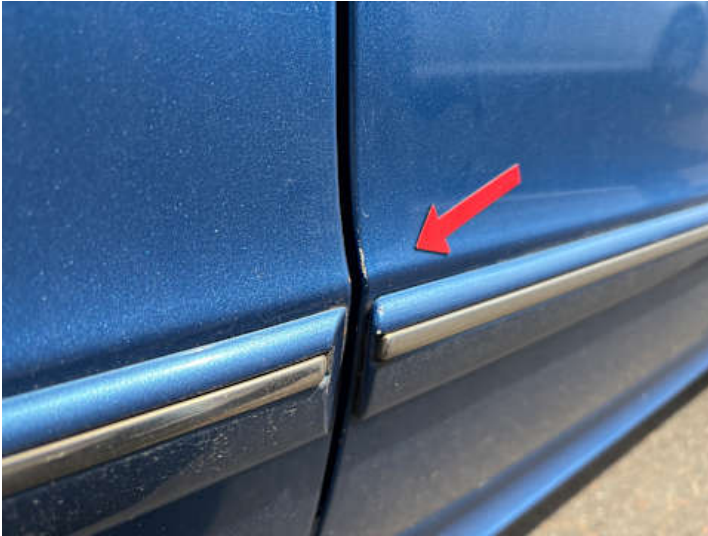
Beifahrertür (Lackschaden, Rost)
