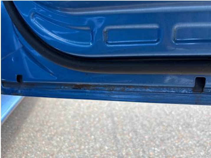
Türe hinten rechts (Rost)
