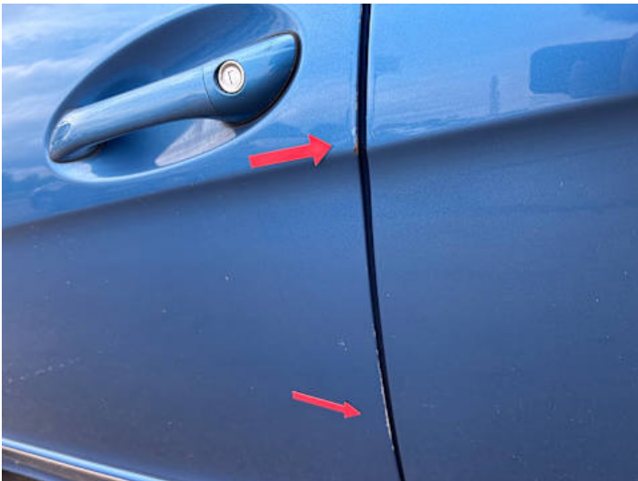
Fahrtür (Rost, Lackschaden)
