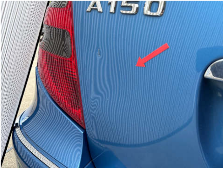
Heckklappe (Verformung, Delle)
