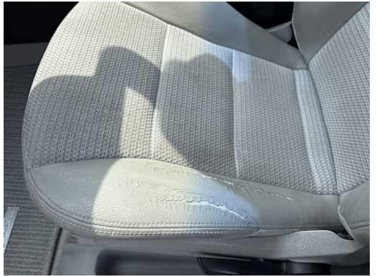
Innenraum (Riss/Bruch, Verschmutzung)
