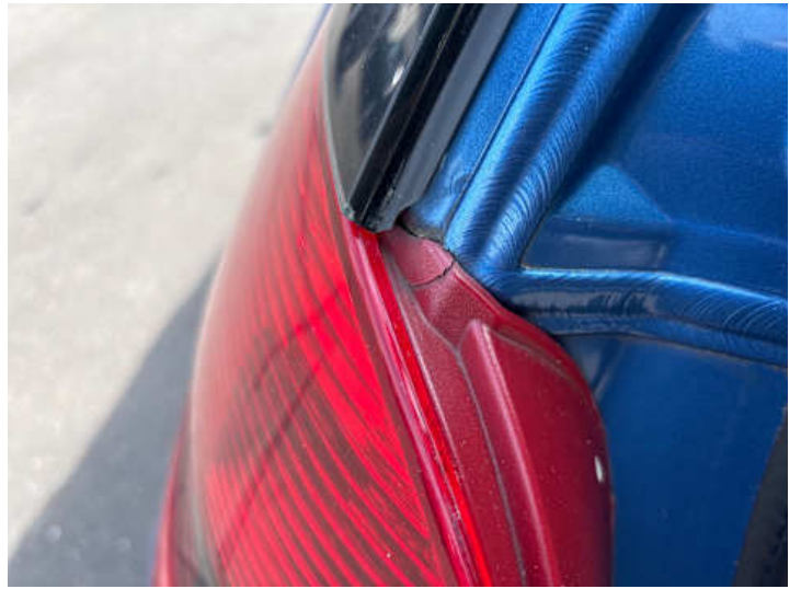
Rücklicht (links) (Riss/Bruch)
