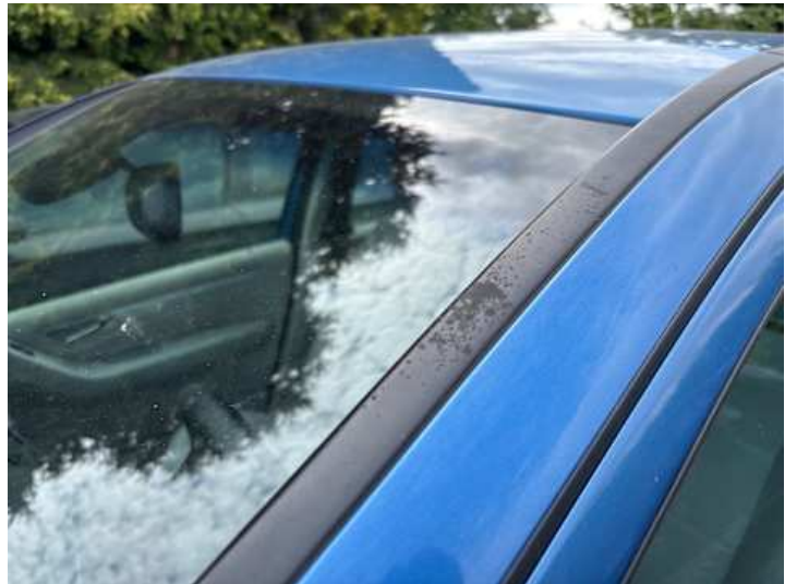
Windschutzscheibe (Anderer Schaden): Verfärbung
