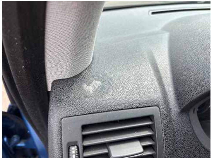
Innenraum (Anderer Schaden): Kleberückstände
