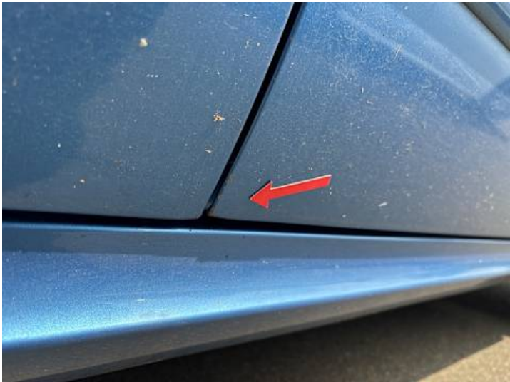
Beifahrertür (Lackschaden, Rost)
