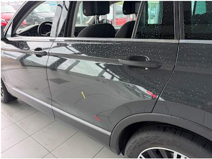
Türe hinten links (Kratzer)
