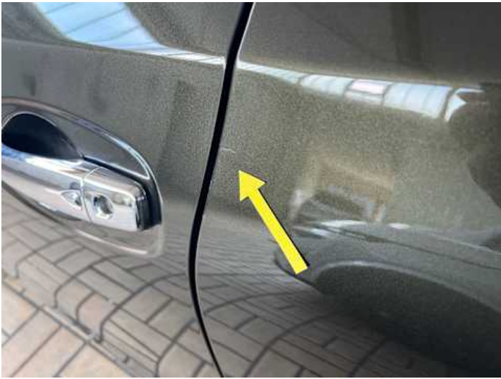
Türe hinten links (Kratzer)
