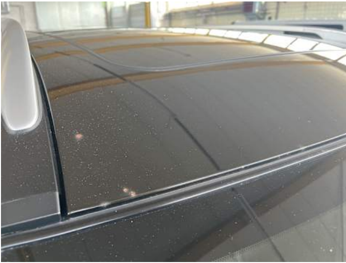
Dach (Rost, Lackschaden)
