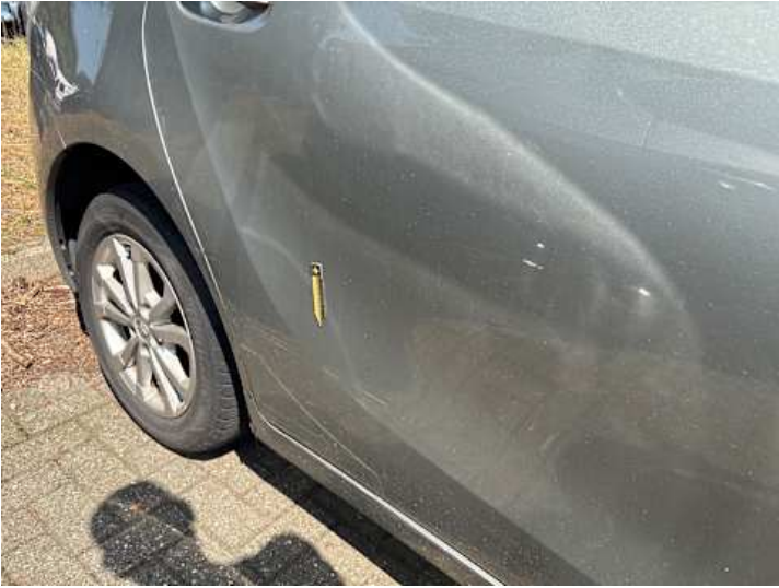
Türe hinten rechts (Verformung)
