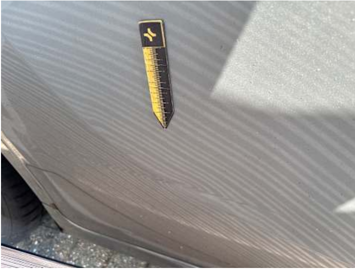
Türe hinten rechts (Verformung)
