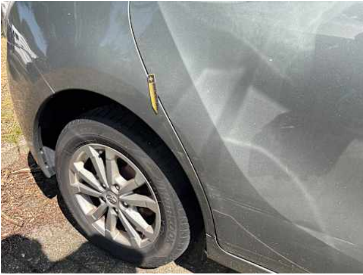
Seitenteil hinten rechts (Verformung)
