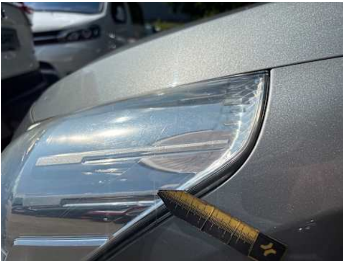
Scheinwerfer (links) (Riss/Bruch)
