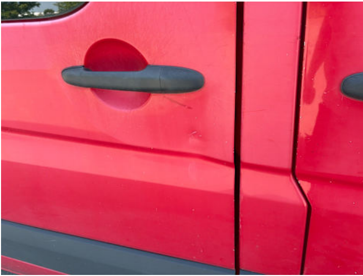
Türe hinten rechts (Lackschaden, Verformung)
