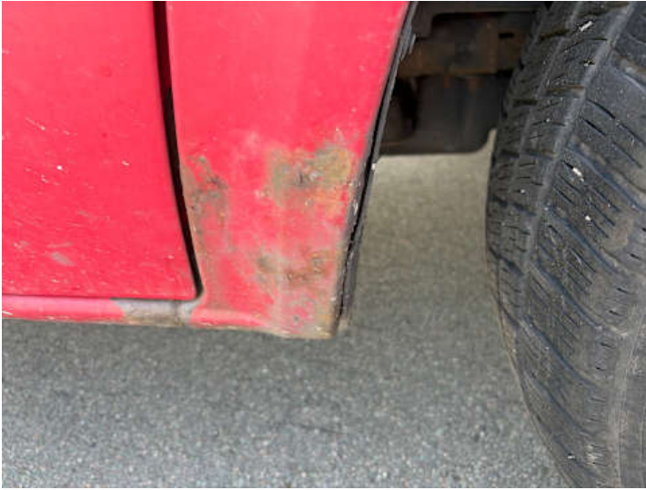
Kotflügel vorne rechts (Rost, Lackschaden)
