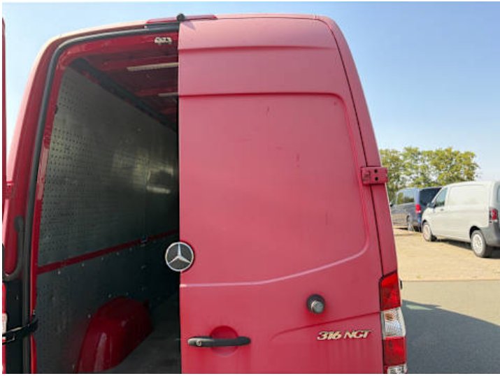
Heckklappe (Kratzer, Lackschaden)
