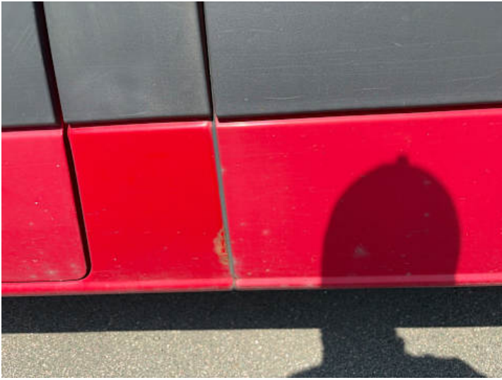
Seitenteil hinten links (Rost, Lackschaden)
