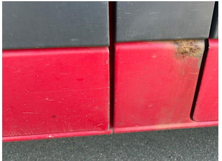
Türe hinten rechts (Lackschaden, Verformung)
