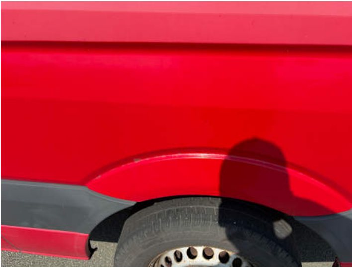
Seitenteil hinten links (Rost, Lackschaden)
