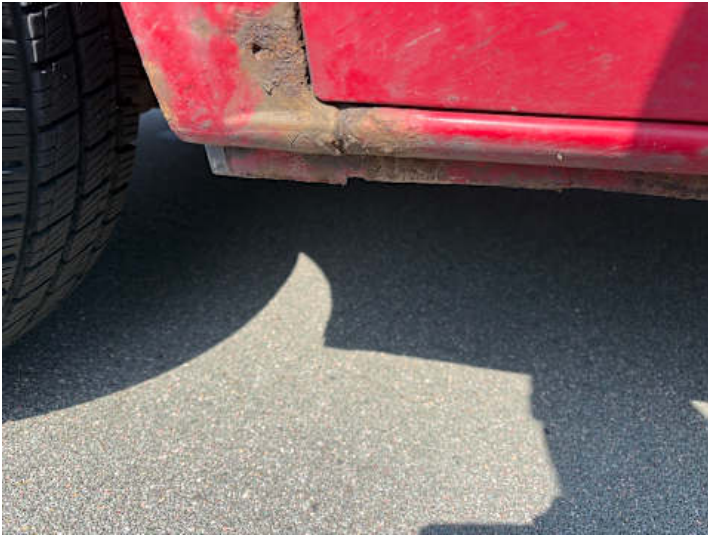
Schweller links (Rost, Lackschaden, Riss/Bruch)
