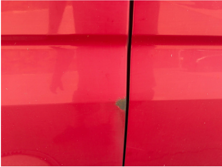
Seitenteil hinten rechts (Rost, Lackschaden)
