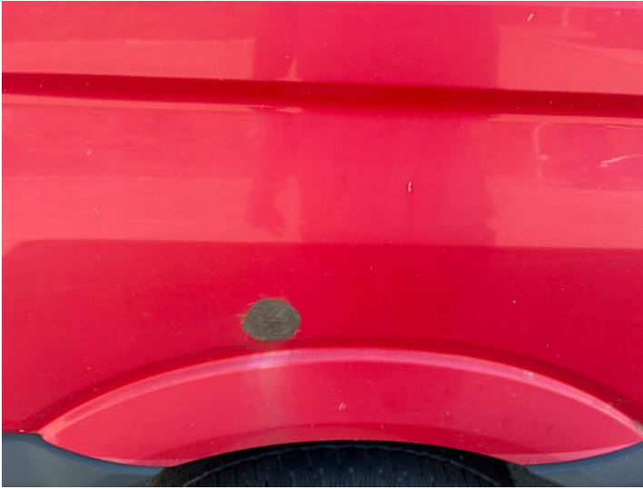
Seitenteil hinten rechts (Rost, Lackschaden)
