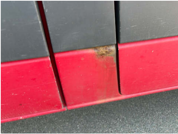
Seitenteil hinten rechts (Rost, Lackschaden)
