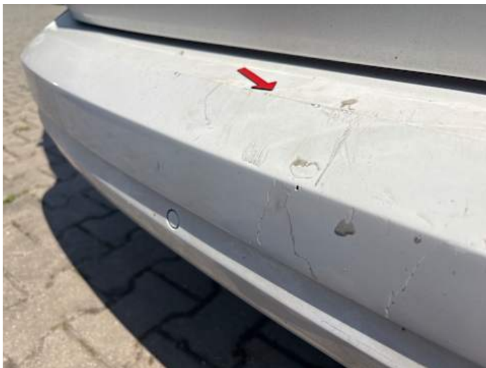
Stoßstange hinten (Kratzer, Lackschaden)
