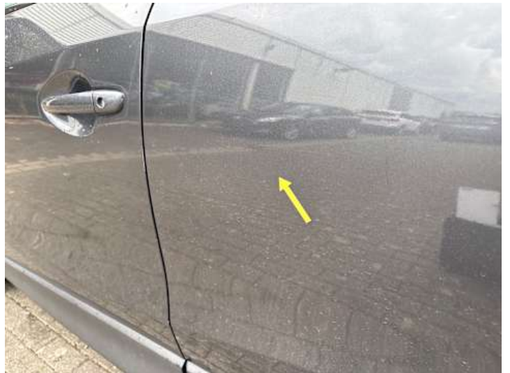
Türe hinten links (Kratzer)
