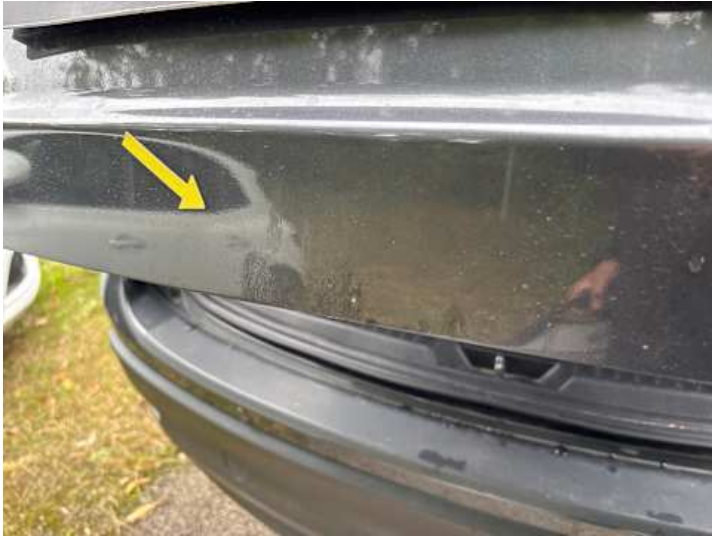
Heckklappe (Kratzer, Lackschaden, Unsachgemäß instand gesetzt)
