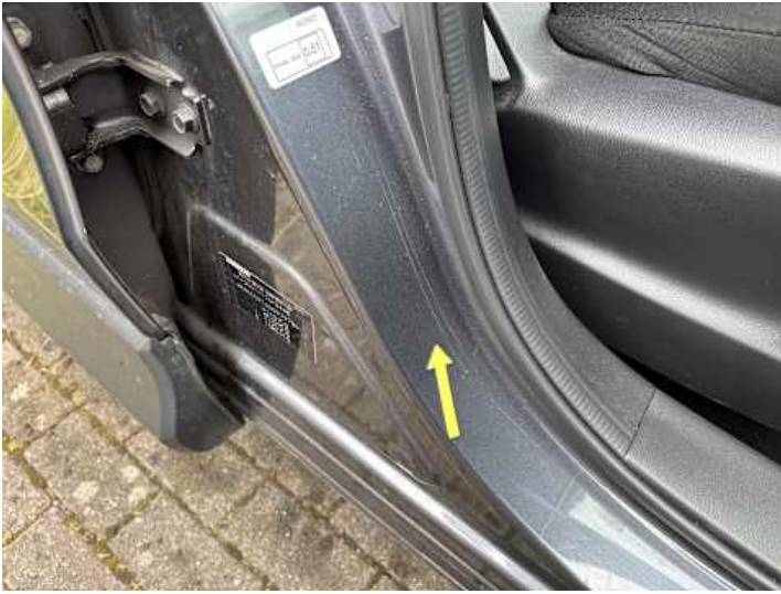
Schweller rechts (Kratzer)
