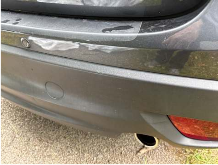
Stoßstange hinten (Kratzer)
