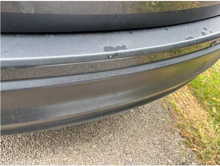
Stoßstange hinten (Kratzer)
