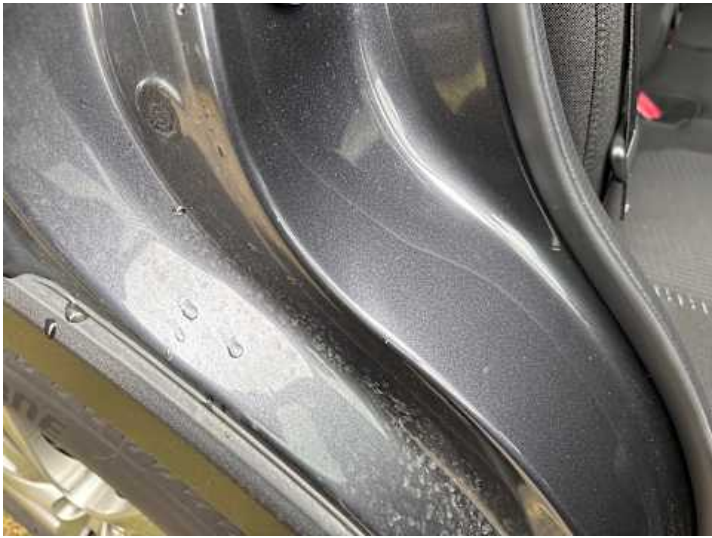
Seitenteil hinten rechts (Kratzer)
