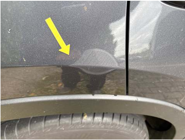
Seitenteil hinten rechts (Kratzer)
