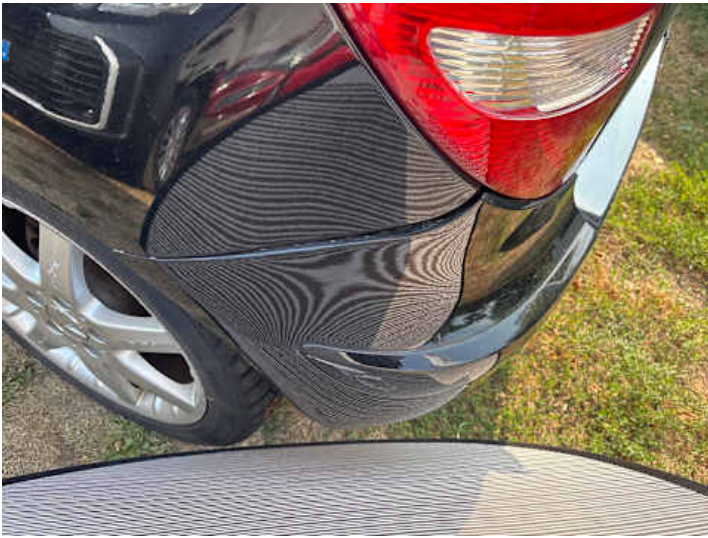
Stoßstange hinten (Spaltmaße ungenau, Verformung, Kratzer)
