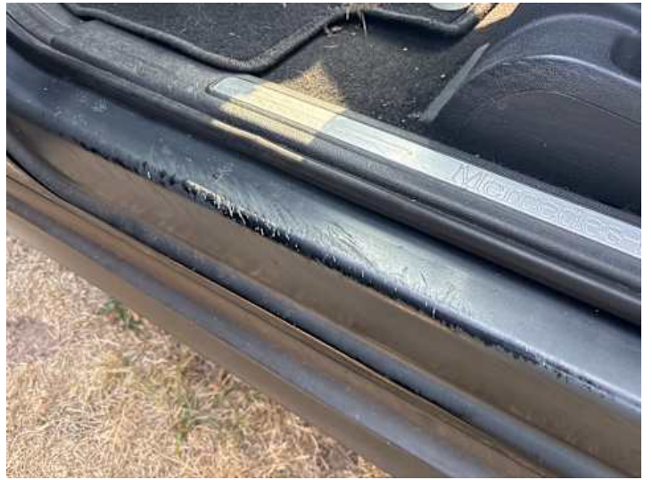
Schweller links (Kratzer, Rost)
