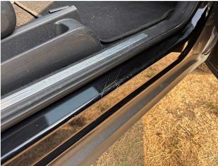
Schweller rechts (Kratzer)
