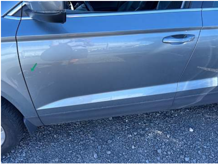
Fahrertür (Unsachgemäß instand gesetzt)
