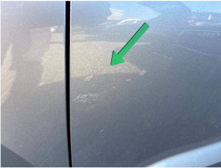
Fahrertür (Unsachgemäß instand gesetzt)
