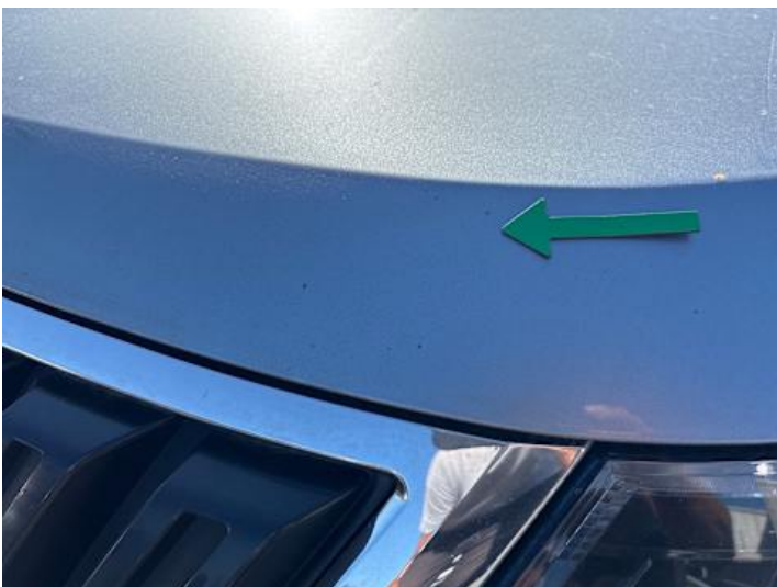
Motorhaube (Rost, Steinschlag)
