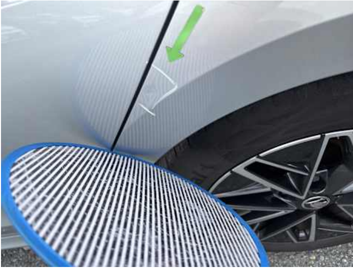
Seitenteil hinten links (Delle)
