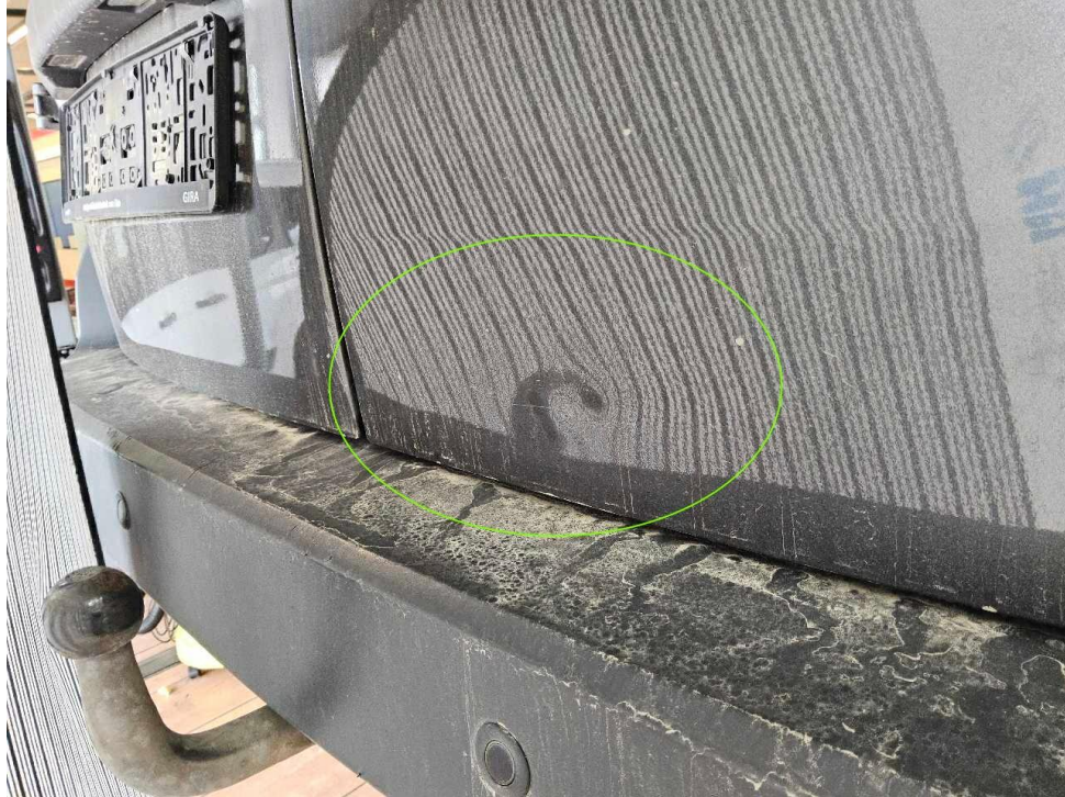
Bild 27 : Hecktür rechts unterhalb eingedrückt und verschürft
