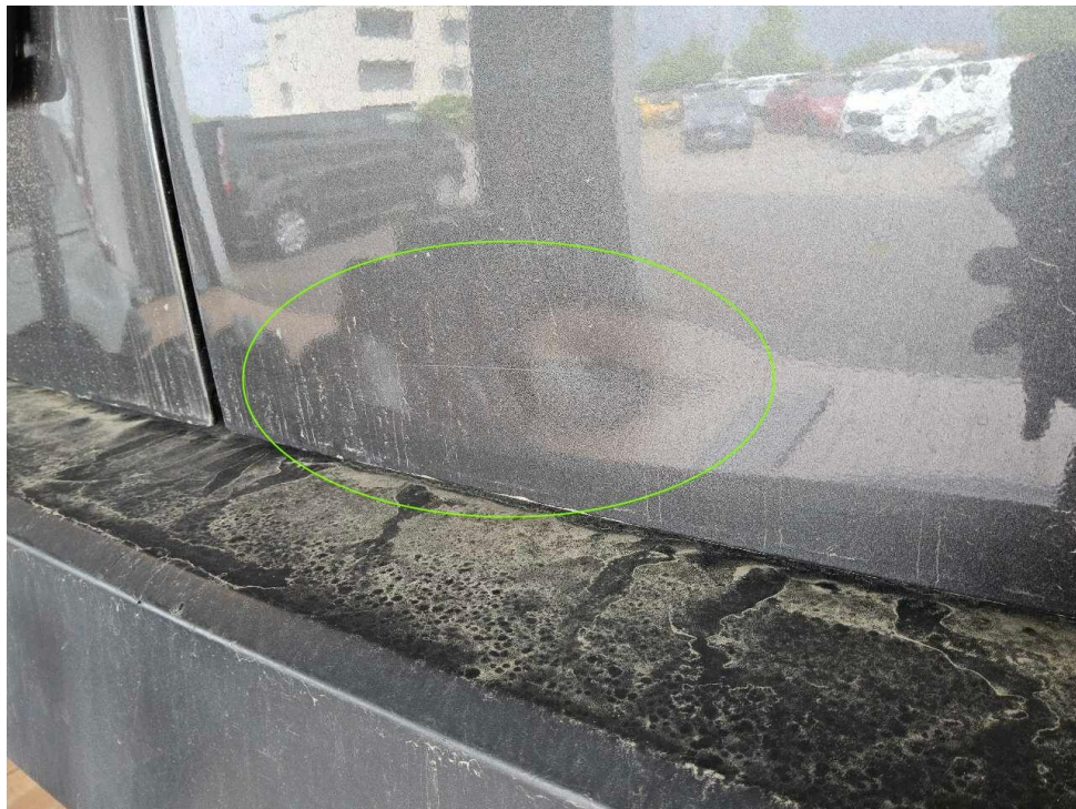
Bild 28 : Hecktür rechts unterhalb eingedrückt und verschürft
