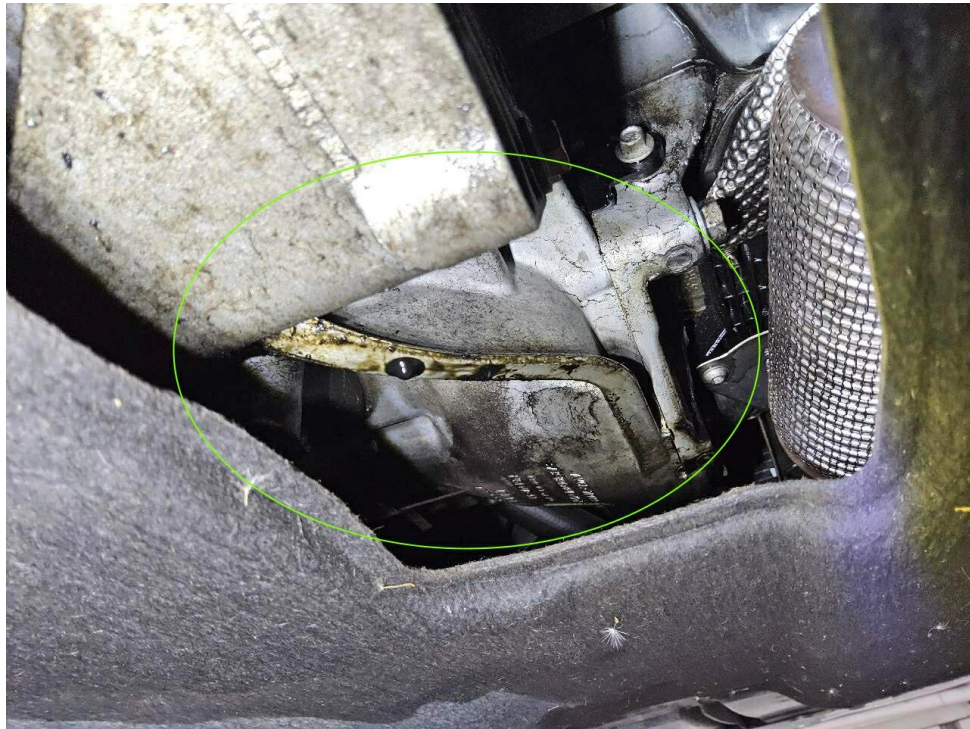
Bild 32 : Motor Ölverlust / Ölfeucht überprüfen und lokalisieren (Schadenerweiterung möglich)
