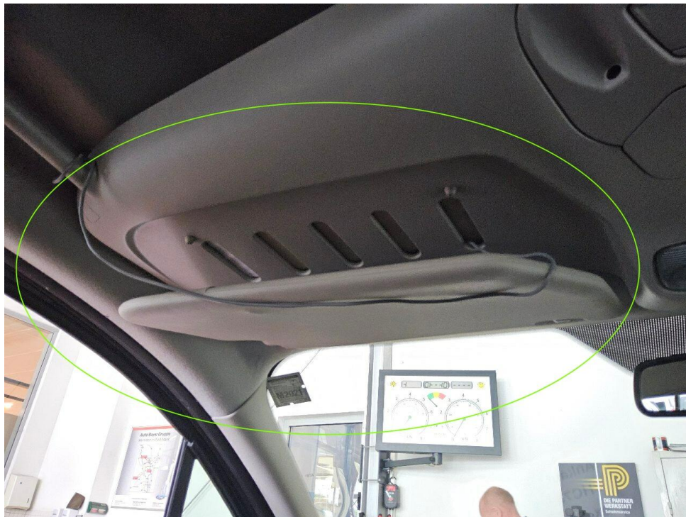
Bild 16 : Sonnenblende Fahrerseite beschädigt
