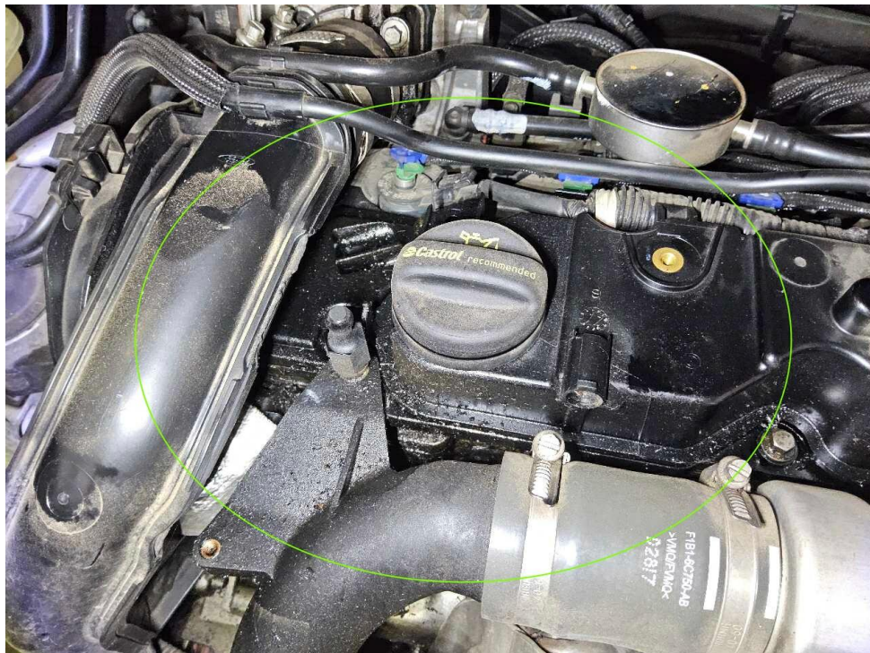
Bild 30 : Motor Ölverlust / Ölfeucht überprüfen und lokalisieren (Schadenerweiterung möglich)
