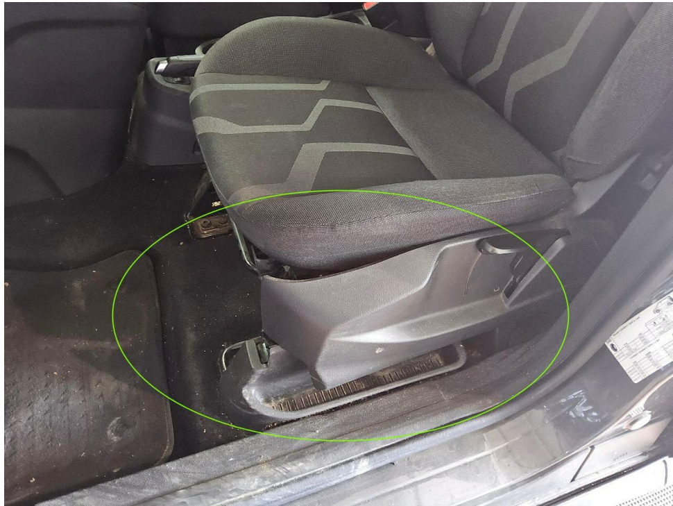
Bild 17 : Fahrersitz Sitzverkleidung gebrochen
