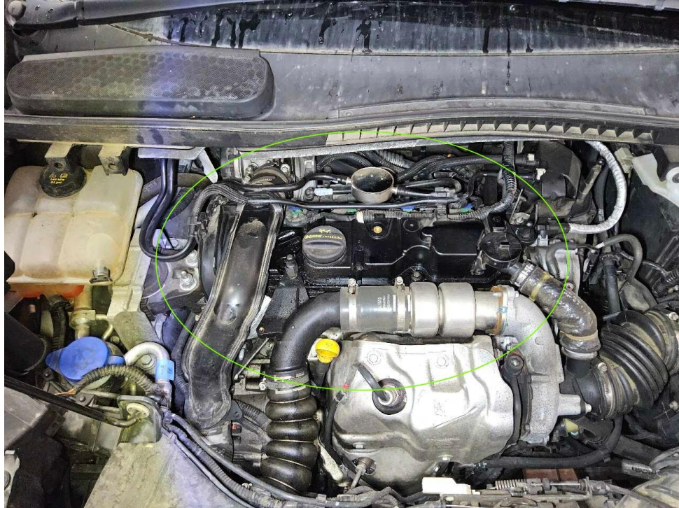
Bild 29 : Motor Ölverlust / Ölfeucht überprüfen und lokalisieren (Schadenerweiterung möglich)
