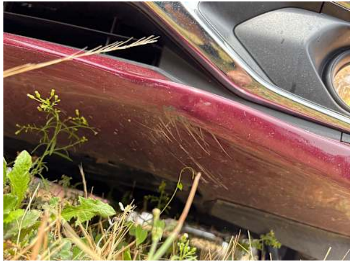
Stoßstange vorne (Kratzer, Lackschaden)
