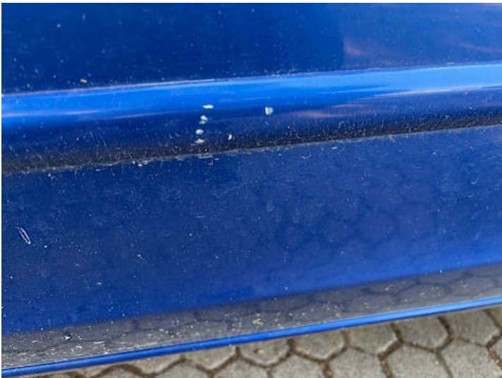
Fahrtür (Lackschaden, Kratzer)
