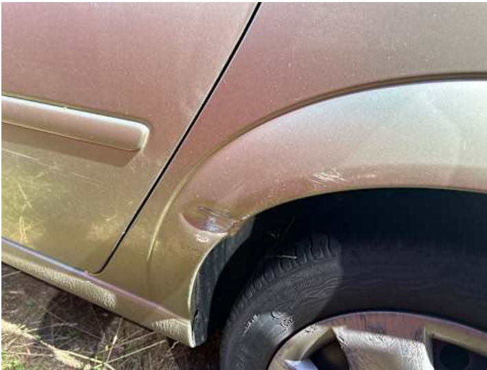
Seitenteil hinten links (Verformung, Lackschaden, Rost)
