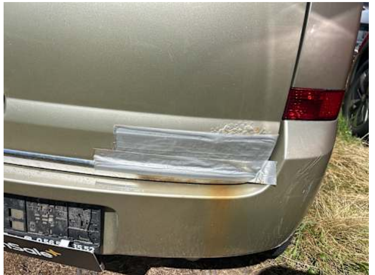
Heckklappe (Rost, Unsachgemäß instand gesetzt)
