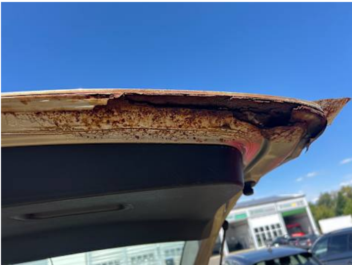
Heckklappe (Rost, Unsachgemäß instand gesetzt)
