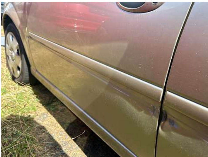
Fahrtür (Verformung, Lackschaden)
