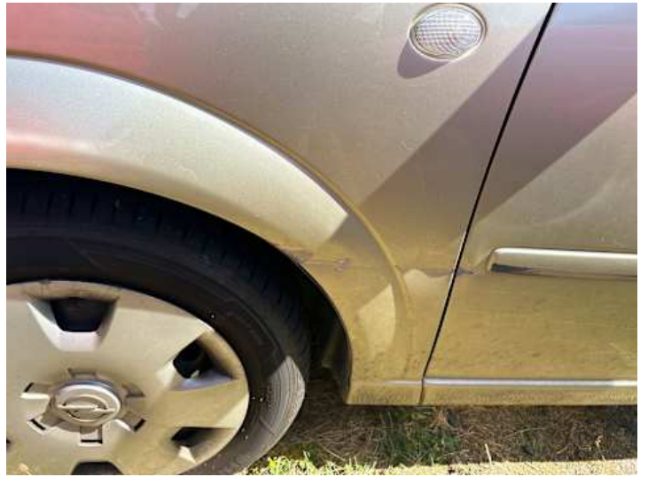
Kotflügel vorne links (Verformung, Lackschaden)
