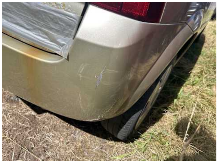
Stoßstange hinten (Kratzer, Lackschaden)
