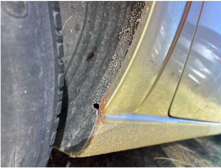
Schweller rechts (Rost)
