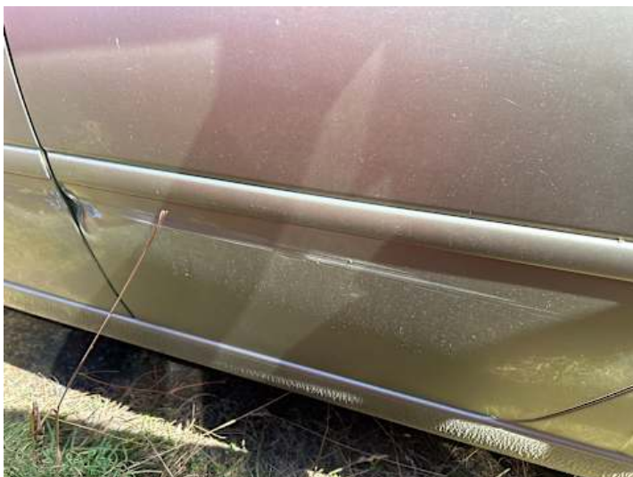
Türe hinten links (Verformung, Lackschaden)
