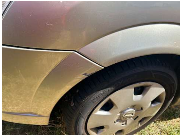
Stoßstange vorne (Lackschaden)
