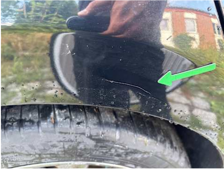
Seitenteil hinten rechts (Kratzer)
