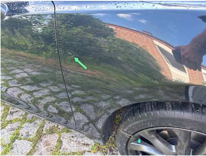
Kotflügel vorne rechts (Delle, Lackschaden)
