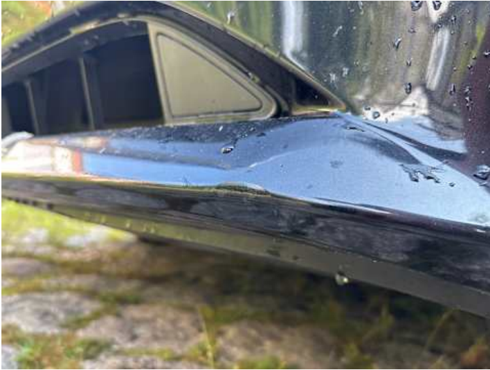
Stoßstange vorne (Verformung)
