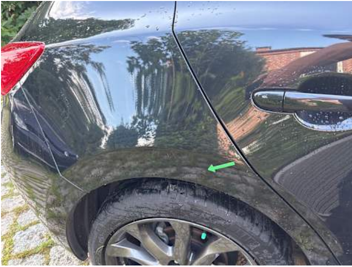
Seitenteil hinten rechts (Kratzer)
