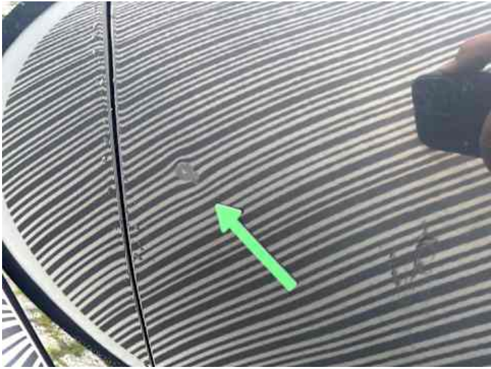
Kotflügel vorne rechts (Delle, Lackschaden)
