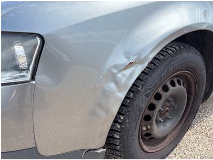
Kotflügel vorne links (Verformung, Rost)
