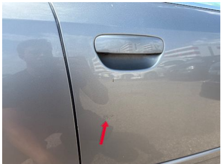
Beifahrtür (Kratzer, Rost)
