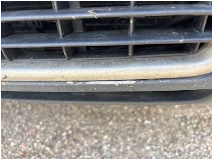
Stoßstange vorne (Riss/Bruch, Kratzer)
