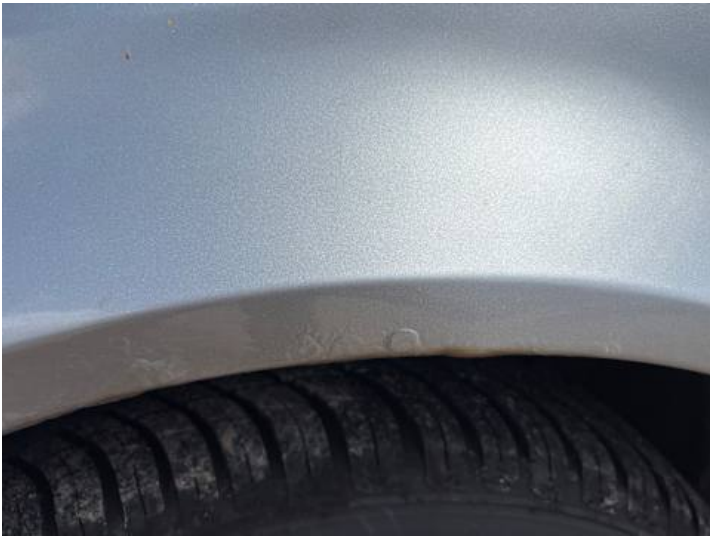
Kotflügel vorne links (Verformung, Rost)
