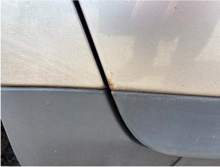
Türe hinten rechts (Rost, Kratzer)
