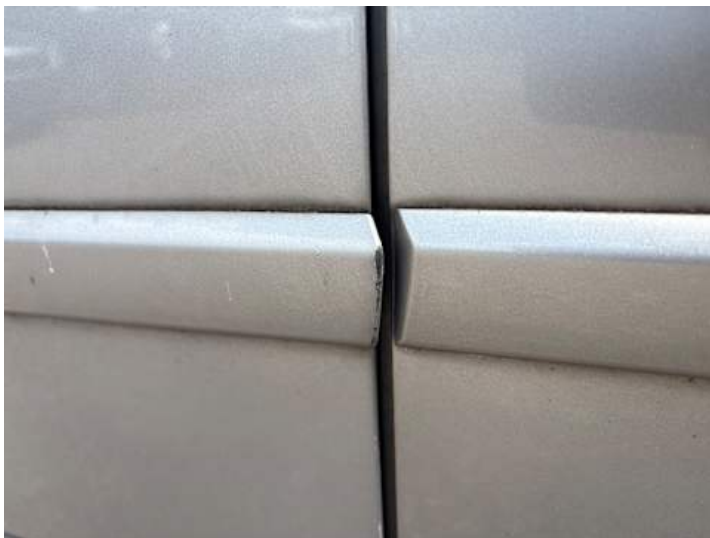
Fahrtür (Kratzer, Rost)
