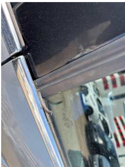
Beifahrtür (Kratzer, Rost)
