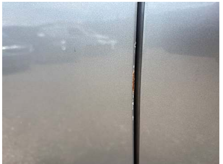
Fahrtür (Kratzer, Rost)
