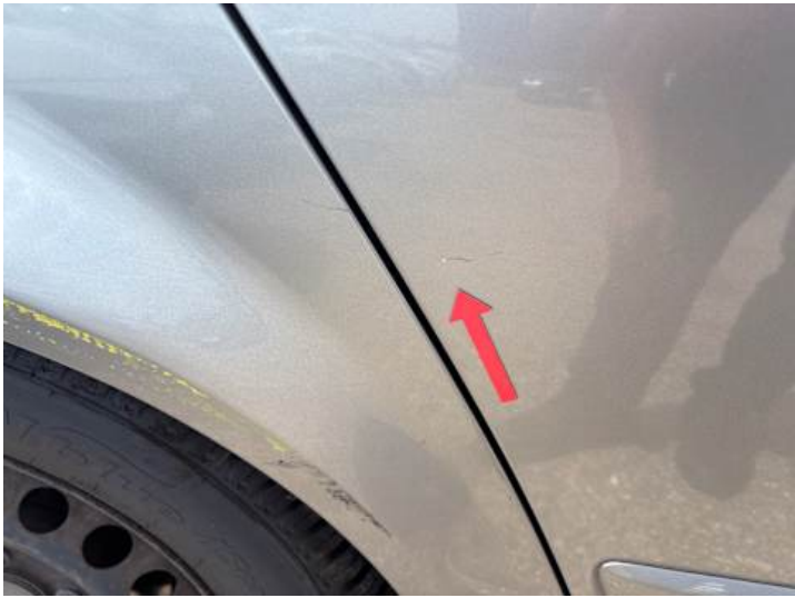
Türe hinten rechts (Rost, Kratzer)
