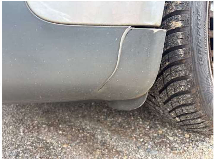
Stoßstange vorne (Riss/Bruch, Kratzer)
