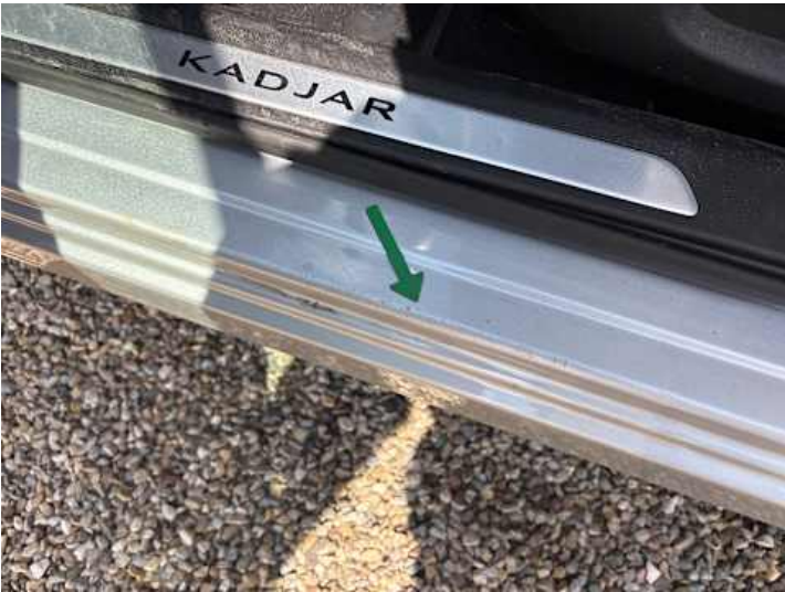
Schweller links (Kratzer, Lackschaden, Delle)
