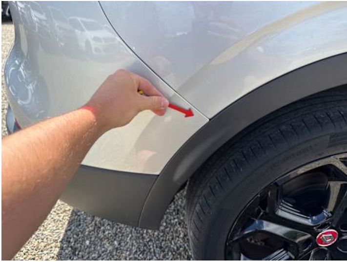
Stoßstange hinten (Kratzer, Lackschaden)
