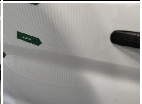
Tür / Rechts / Delle
