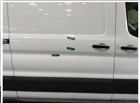
Tür / Rechts / Delle
