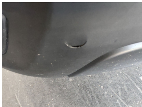
Stoßfänger unterhalb / Vorne / Gebrochen
