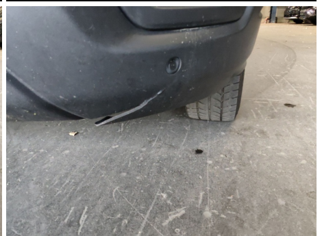
Stoßfänger unterhalb / Vorne / Gebrochen
