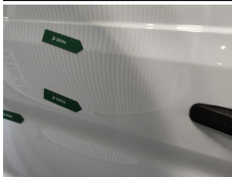
Tür / Rechts / Delle
