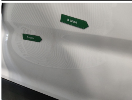
Tür / Rechts / Delle
