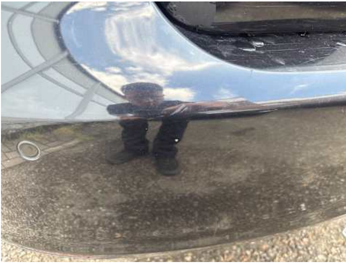
Stoßstange hinten (Spaltmaße ungenau, Lackschaden, Verformung, Unsachgemäß instand gesetzt)
