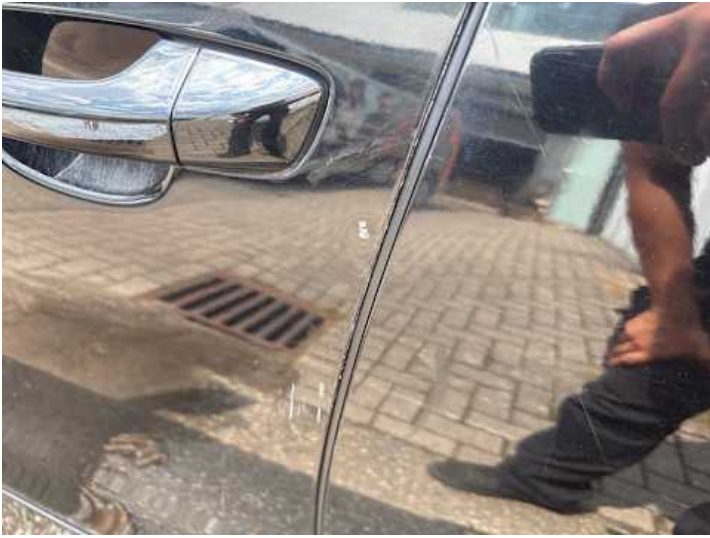
Fahrtür (Kratzer, Lackschaden, Delle)
