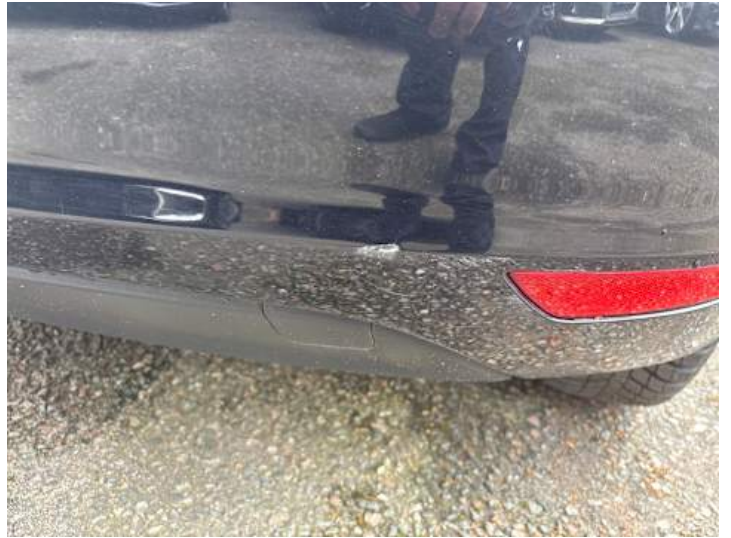
Stoßstange hinten (Spaltmaße ungenau, Lackschaden, Verformung, Unsachgemäß instand gesetzt)
