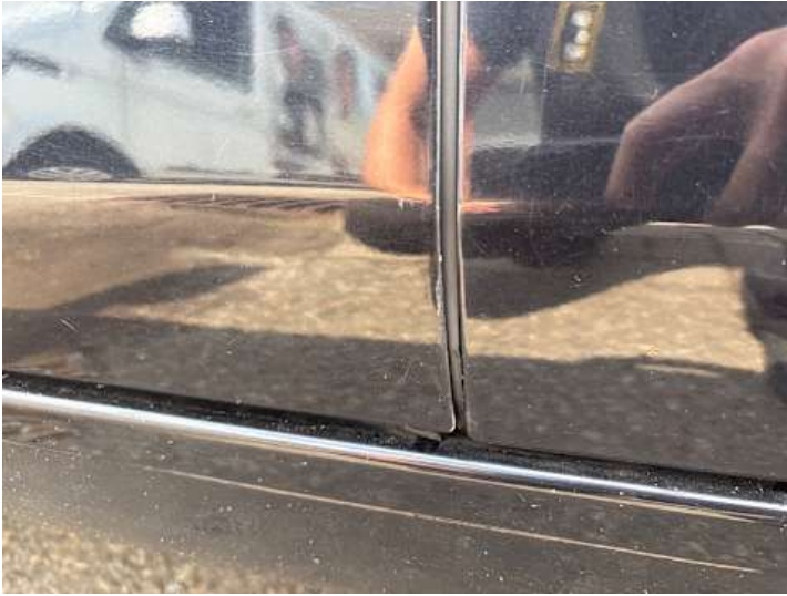
Fahrtür (Kratzer, Lackschaden, Delle)
