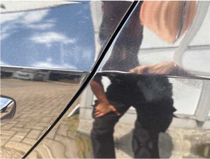
Türe hinten links (Lackschaden, Kratzer, Delle, Anderer Schaden): Tür öffnet nur schwer von innen
