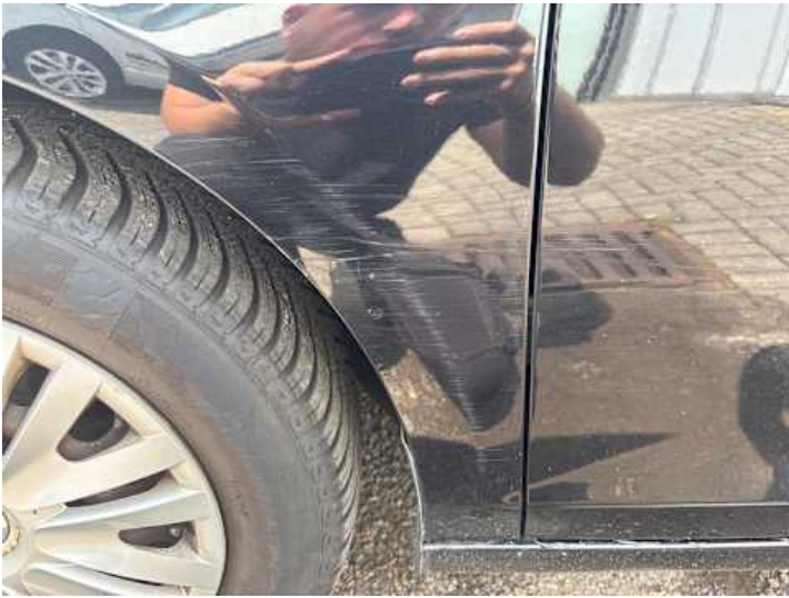
Kotflügel vorne links (Kratzer, Rost)
