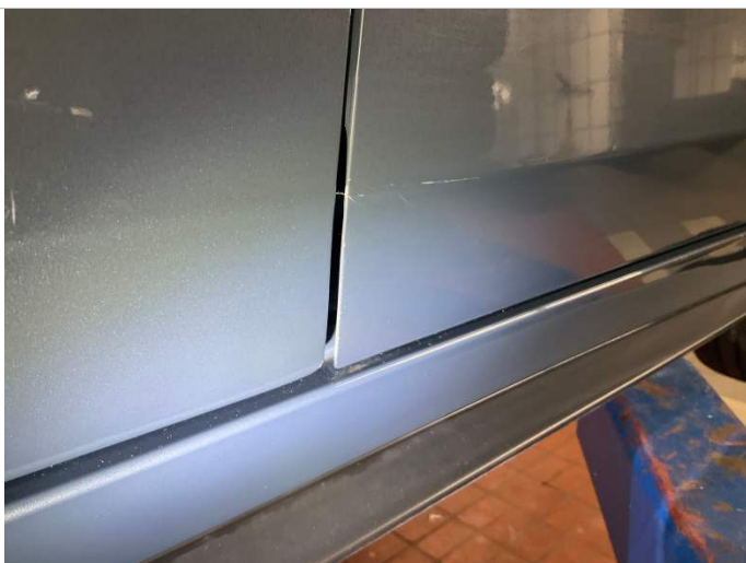
Türe hinten links Türkante Lackbeschädigung und Türe Kratzer
