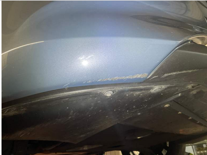
Stoßfänger vorne links und rechts Schürfungen
