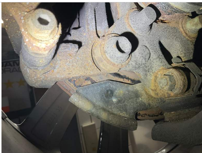
Bremsscheiben Vorderachse Innenseite Tragbild mangelhaft
