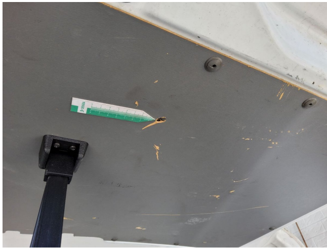
Heckklappenverkleidung beschädigt (DEKRA)
