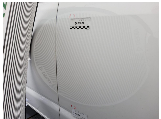
Tür vorne rechts, mehrfach eingedellt, Gebrauchsspur (DEKRA)
