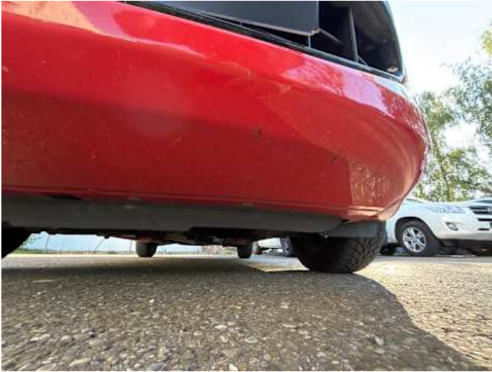
Stoßstange vorne (Kratzer, Lackschaden)
