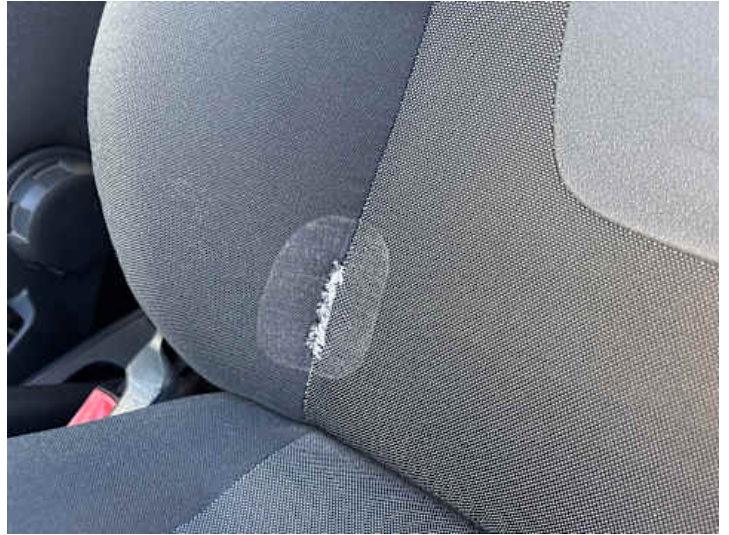
Innenraum (Riss/Bruch, Verschleiß)
