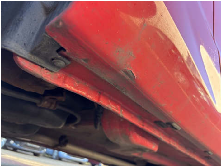
Schweller rechts (Lackschaden, Kratzer, Verformung)
