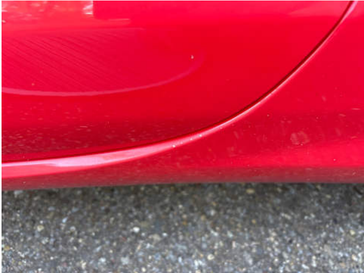
Schweller links (Lackschaden, Delle)
