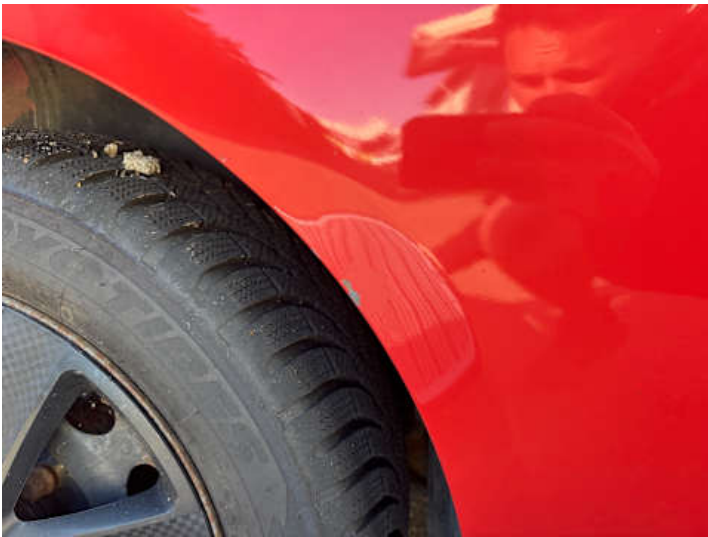
Seitenteil hinten rechts (Lackschaden, Unsachgemäß instand gesetzt)
