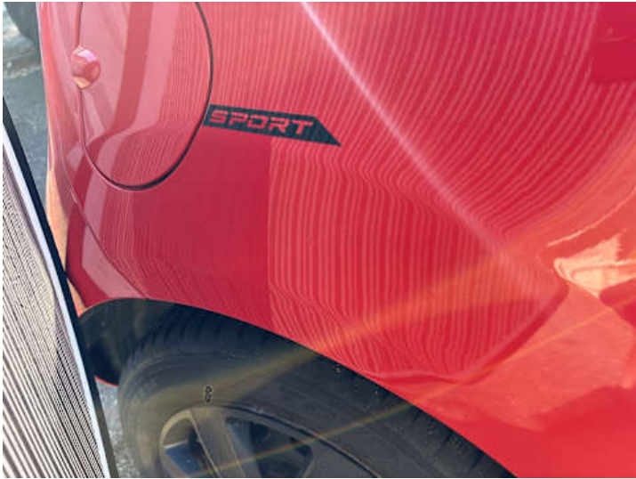
Seitenteil hinten rechts (Lackschaden, Unsachgemäß instand gesetzt)
