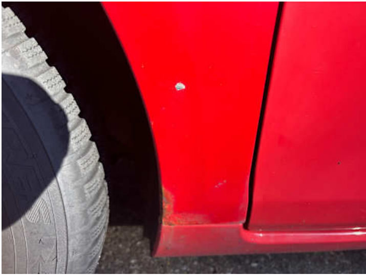
Kotflügel vorne links (Lackschaden, Unsachgemäß instand gesetzt, Ausgeblichen/Matt, Rost)
