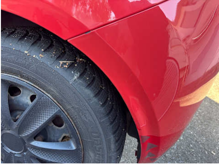
Stoßstange hinten (Kratzer, Lackschaden)
