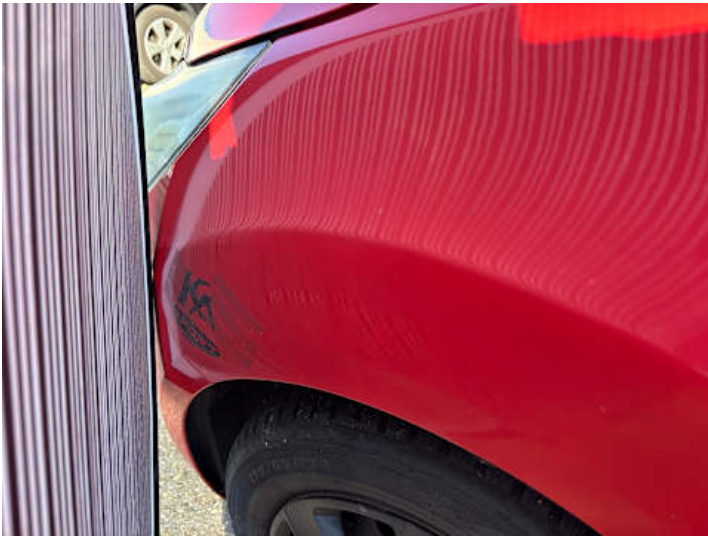
Kotflügel vorne links (Lackschaden, Unsachgemäß instand gesetzt, Ausgeblichen/Matt, Rost)
