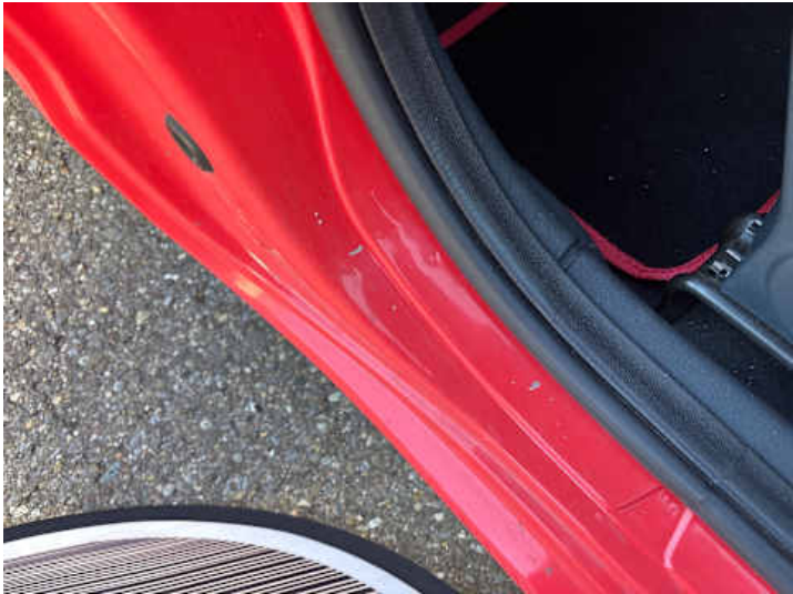
Schweller rechts (Lackschaden, Kratzer, Verformung)
