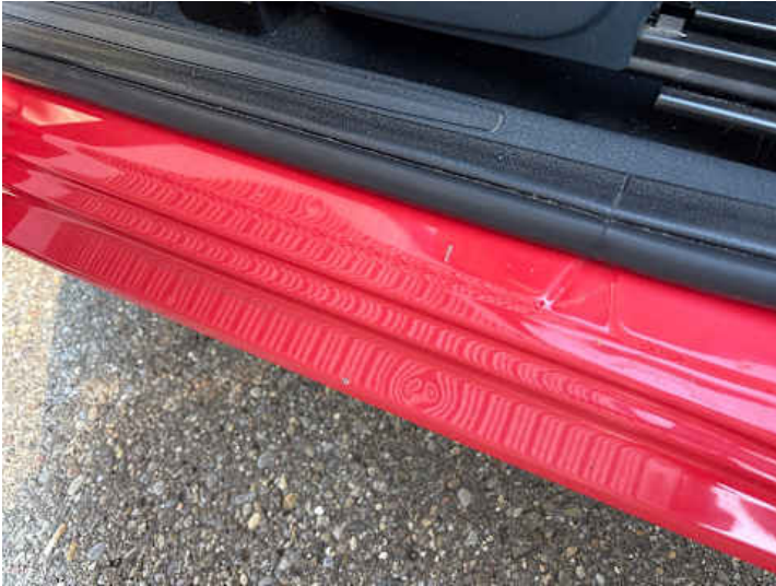
Schweller links (Lackschaden, Delle)
