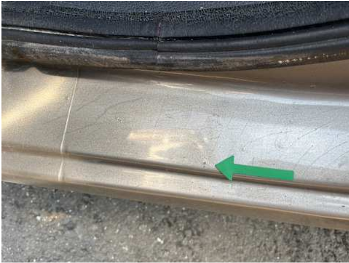
Schweller links (Rost)
