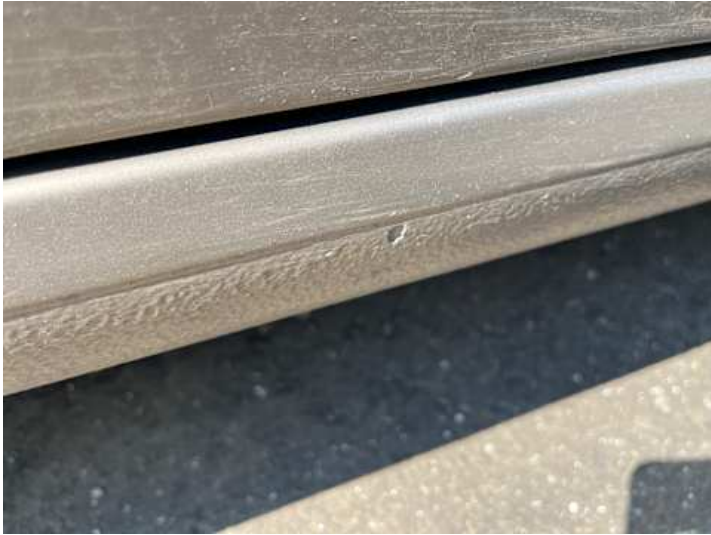
Schweller rechts (Lackschaden)
