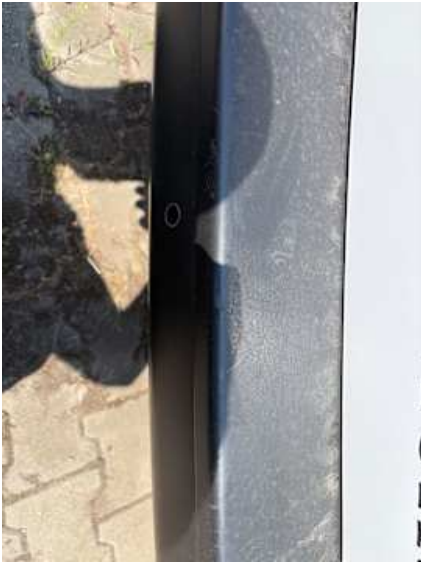
Stoßstange hinten (Lackschaden, Verformung)
