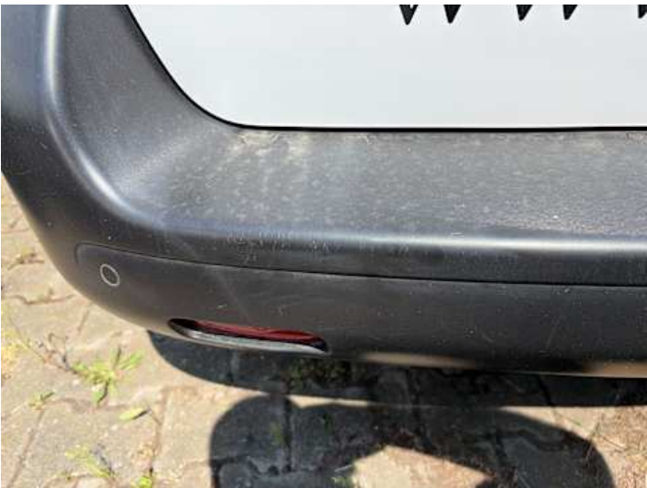
Stoßstange hinten (Lackschaden, Verformung)
