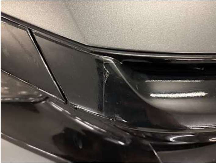
Stoßstange vorne (Unsachgemäß instand gesetzt)
