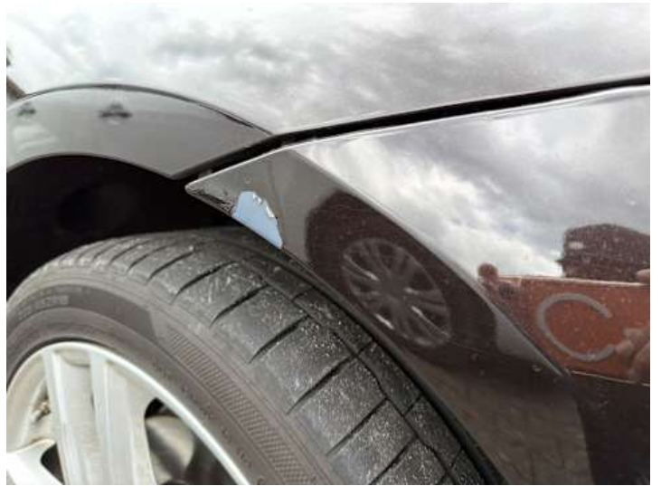
Stoßstange vorne (Lackschaden, Spaltmaße ungenau)
