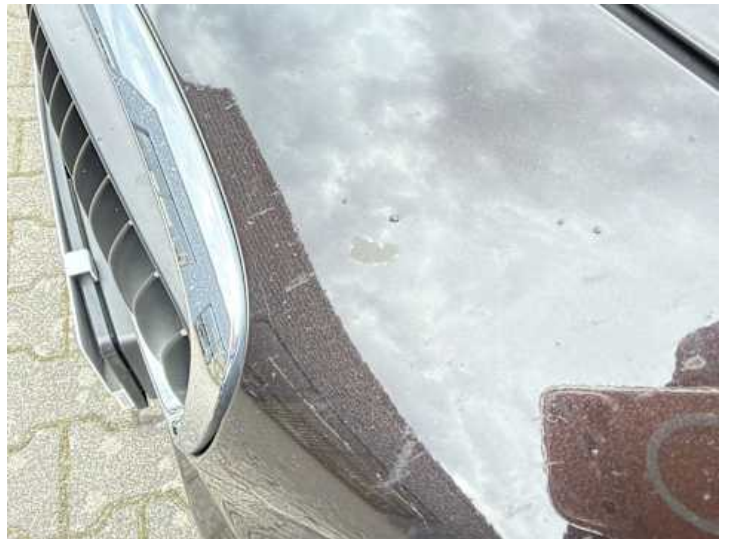
Stoßstange vorne (Lackschaden, Spaltmaße ungenau)
