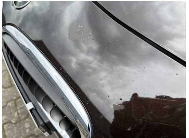
Stoßstange vorne (Lackschaden, Spaltmaße ungenau)
