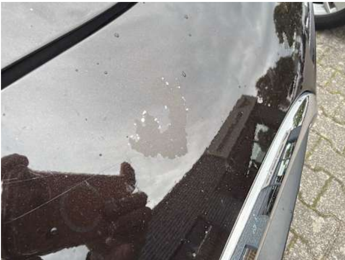
Stoßstange vorne (Lackschaden, Spaltmaße ungenau)
