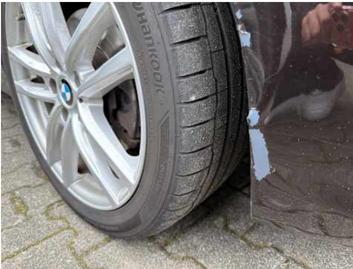
Stoßstange vorne (Lackschaden, Spaltmaße ungenau)
