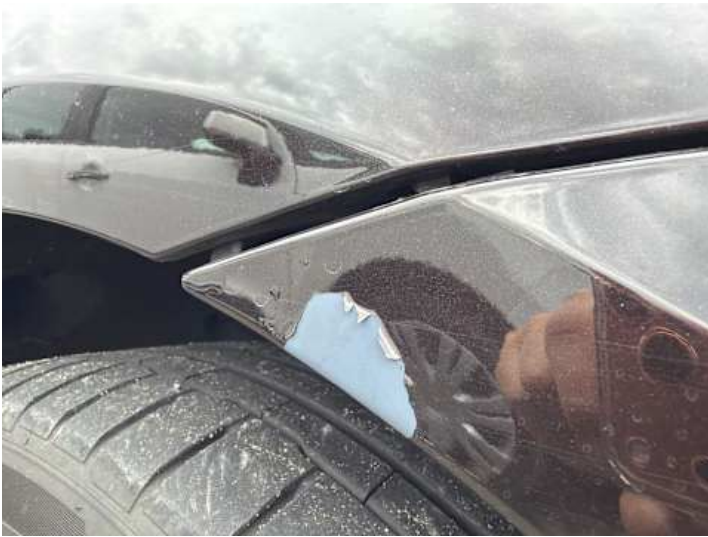
Stoßstange vorne (Lackschaden, Spaltmaße ungenau)
