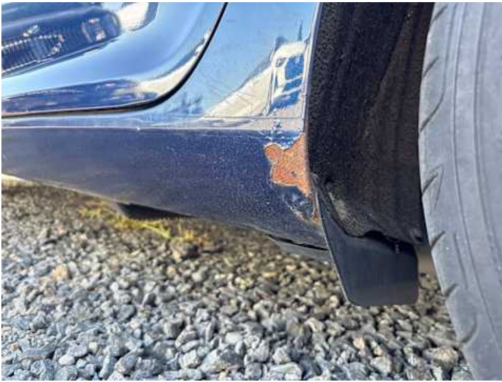
Schweller links (Rost)
