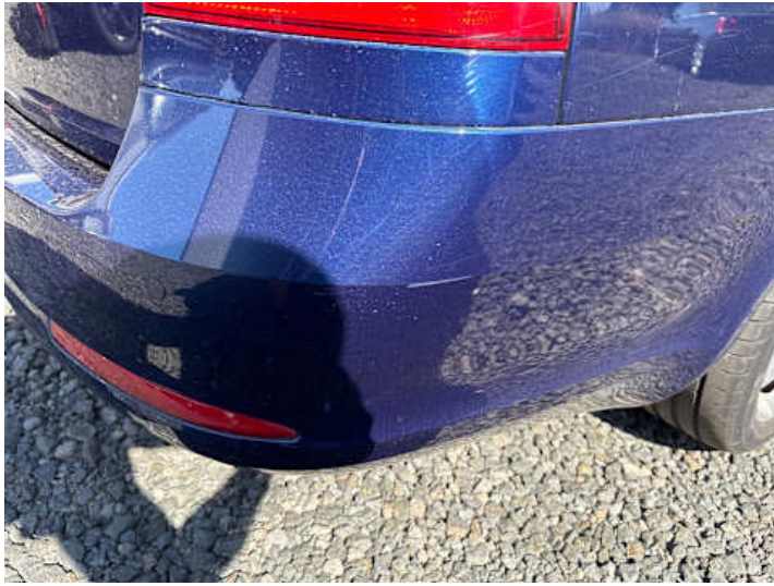
Stoßstange hinten (Kratzer, Lackschaden)
