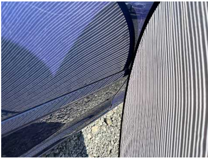
Türe hinten rechts (Delle)
