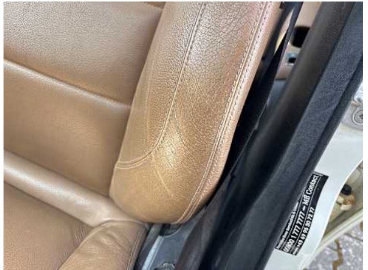
Innenraum (Verschmutzung, Verschleiß)
