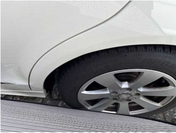
Seitenteil hinten links (Verformung)
