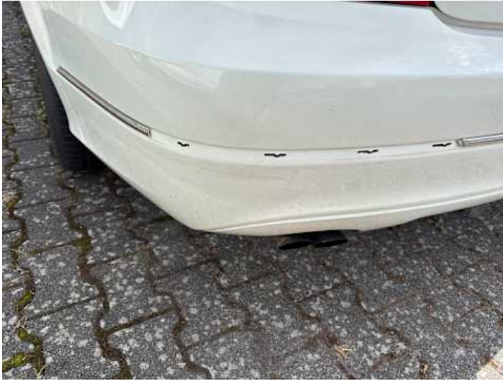
Stoßstange hinten (Anderer Schaden): Leiste fehlt
