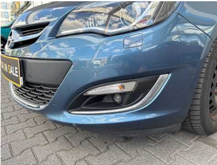
Stoßstange vorne (Verformung, Riss/Bruch, Lackschaden)
