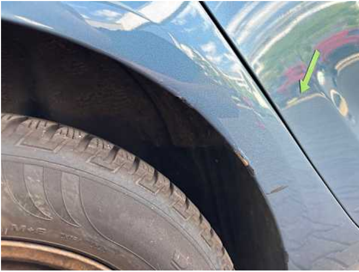
Seitenteil hinten rechts (Lackschaden, Delle, Rost)
