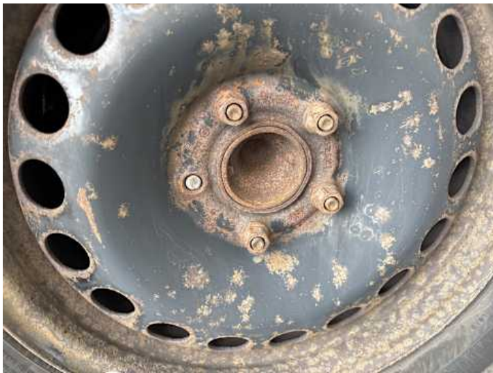
Rad (Anderer Schaden): Bolzen abgerissen
