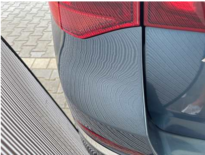
Stoßstange hinten (Unsachgemäß instand gesetzt)
