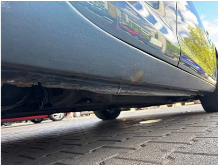
Schweller rechts (Rost, Verformung)
