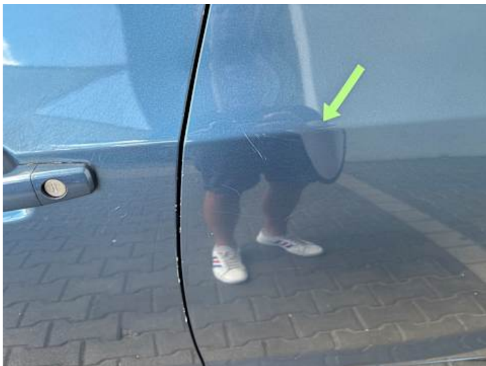
Türe hinten links (Kratzer)
