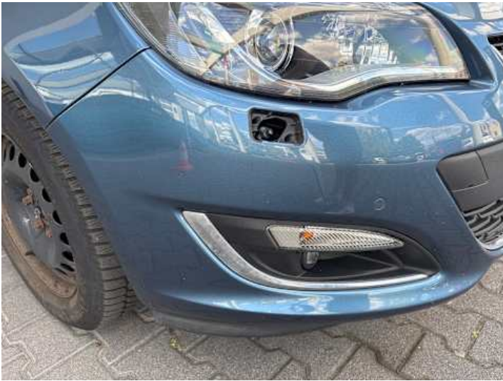
Stoßstange vorne (Verformung, Riss/Bruch, Lackschaden)
