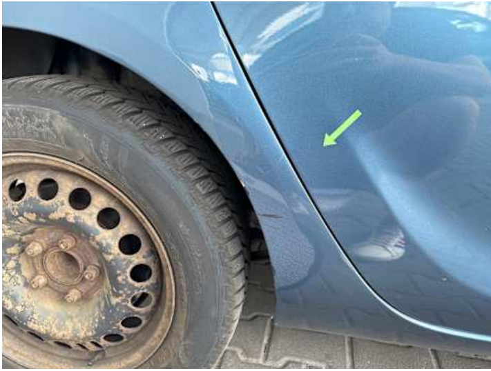
Seitenteil hinten rechts (Lackschaden, Delle, Rost)
