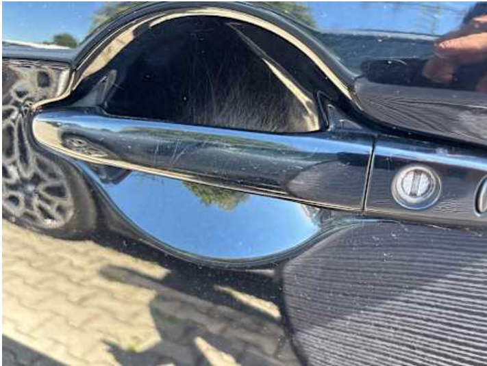
Fahrertür (Lackschaden, Kratzer)
