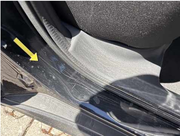
Schweller rechts (Lackschaden)
