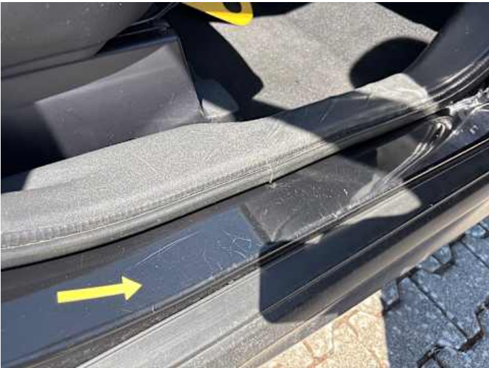
Schweller rechts (Lackschaden)
