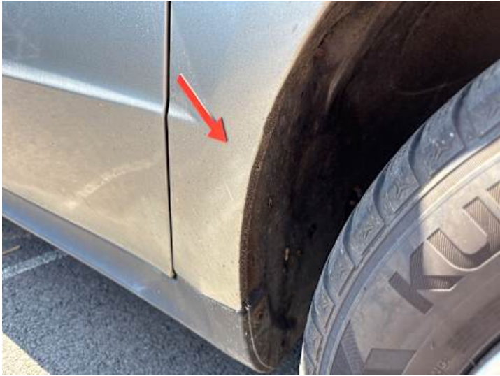
Kotflügel vorne rechts (Rost)
