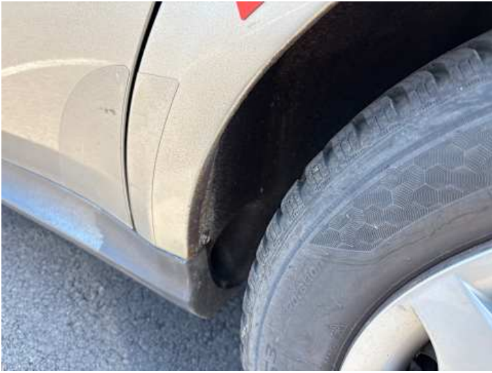
Seitenteil hinten links (Rost)
