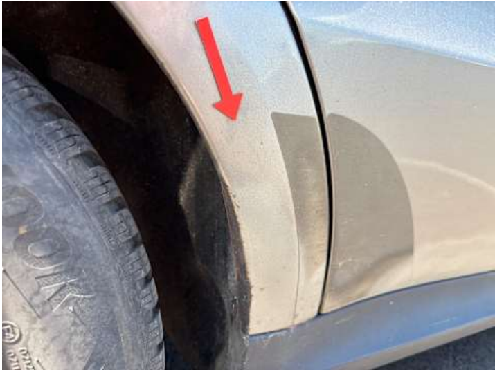
Seitenteil hinten rechts (Rost)
