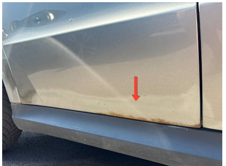
Türe hinten rechts (Rost)
