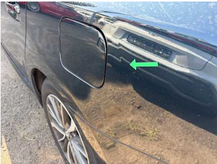
Seitenteil hinten links (Verformung)
