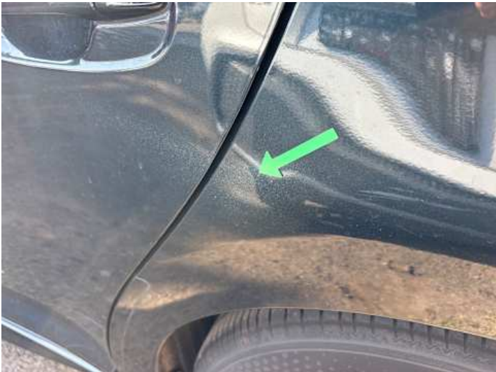
Seitenteil hinten links (Verformung)
