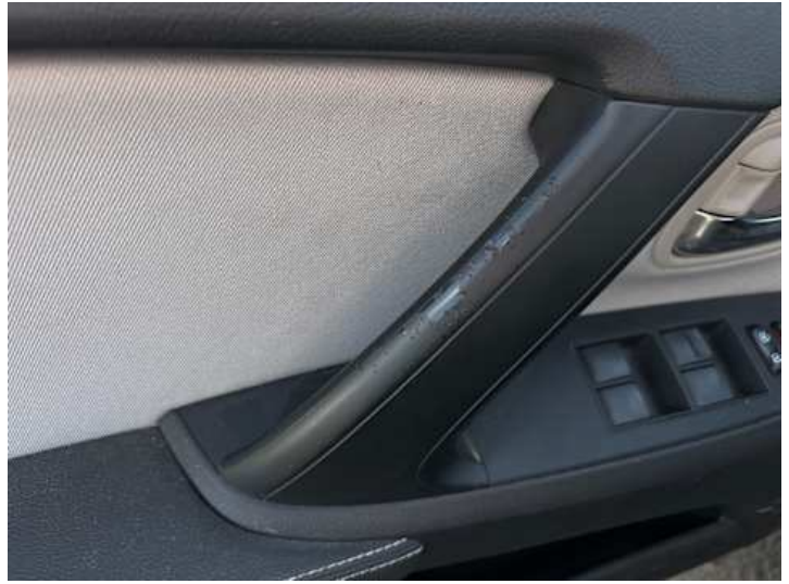
Innenraum (Verschmutzung, Verschleiß)
