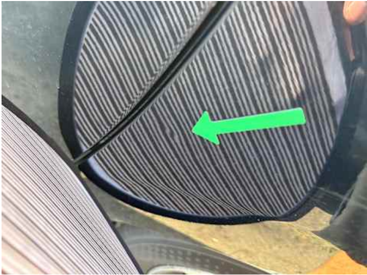
Seitenteil hinten links (Verformung)
