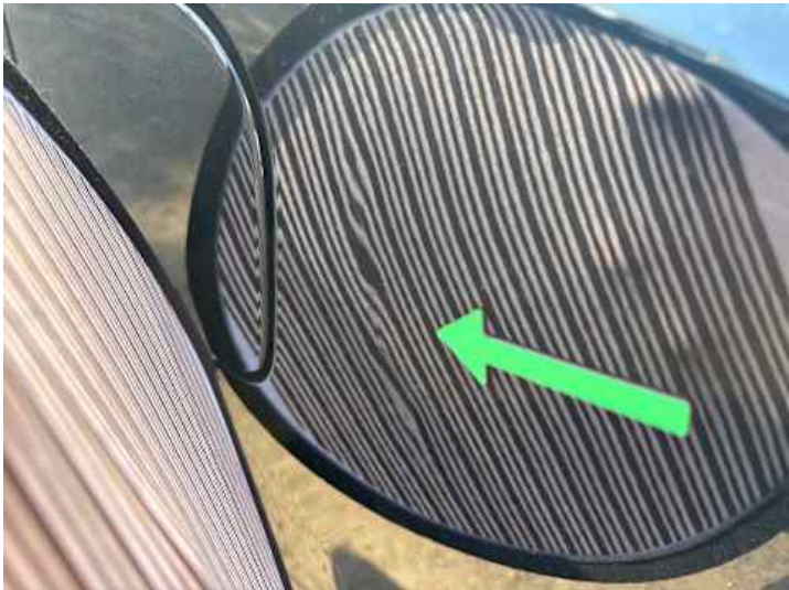
Seitenteil hinten links (Verformung)
