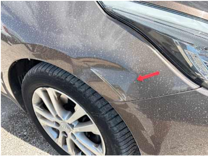
Kotflügel vorne rechts (Lackschaden, Delle, Verformung)
