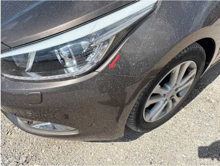
Stoßstange vorne (Spaltmaße ungenau)
