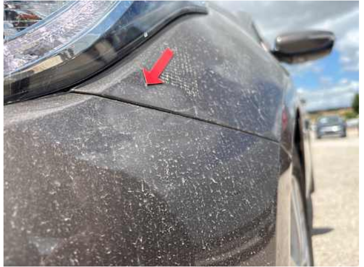
Stoßstange vorne (Spaltmaße ungenau)
