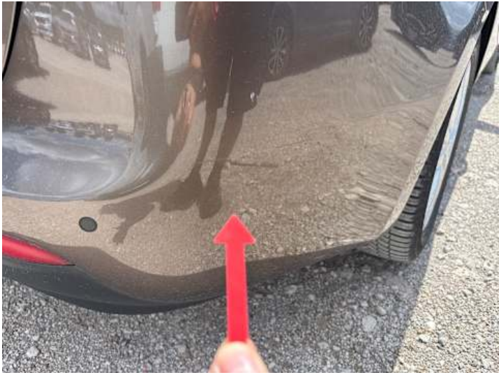
Stoßstange hinten (Kratzer)
