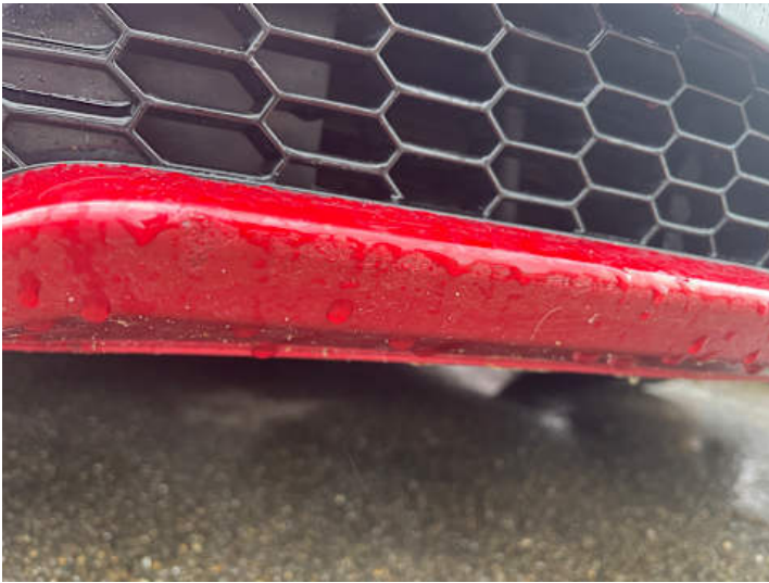
Stoßstange vorne (Lackschaden)
