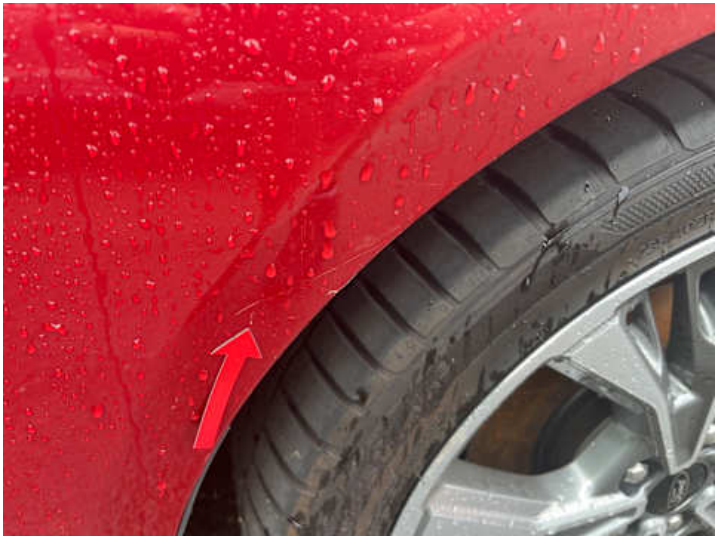
Kotflügel vorne rechts (Kratzer)
