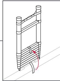
**6** Leiter vor dem Losfahren wieder vom Dachzelt abmontieren und im Dachzelt oder Auto verstauen.
