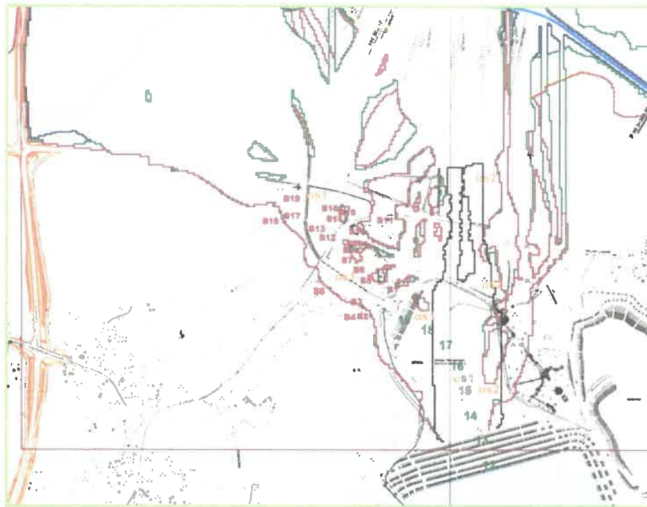
Slika 11: Razlivna območja ob porušitvi pregrade Bukovžlak ob 100 letnih vodah (slika iz študije)
