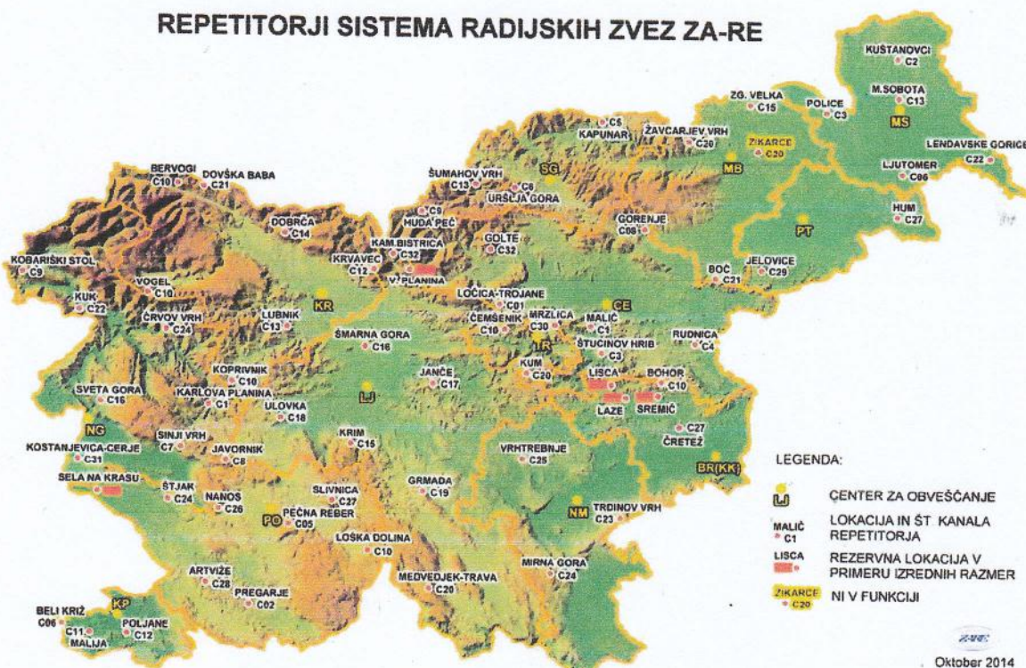
Slika 25: Repetitorske postaje s kanali sistema ZA-RE
