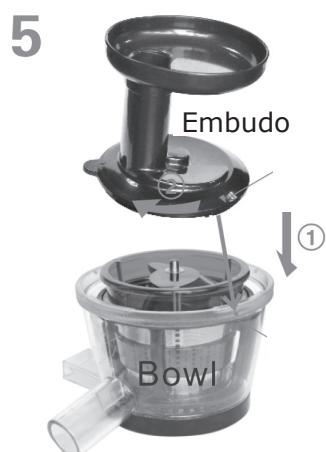
5. Coloque el embudo encima del tazón y asegúrese de que la flecha del embudo señale hacia el punto rojo del tazón.
