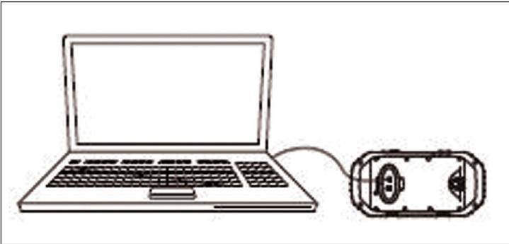
Cargue la batería integrada conectando el Poolboy al PC mediante un cable USB (incluido en el suministro).
