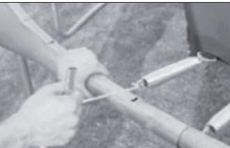
Legen Sie die Sprungmatte mit der abgestickten Seite nach unten in die Mitte des Grundgerüstes und beginnen Sie Sprungmatte und Grundgerüst mit Hilfe der Federn zu verbunden. Nutzen Sie hierzu das Federeinspannwerkzeug wie abgebildet.
