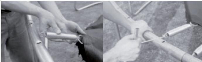
Coloque la colchoneta con la parte marcada hacia abajo en el centro de la estructura y comience a unir la colchoneta con la estructura utilizando los muelles. Utilice para ello la herramienta tensora para los muelles como se muestra en la imagen.
