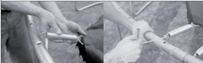
Posizionare il tappeto elastico al centro del telaio con il lato cucito rivolto verso il basso. Collegare il tappeto elastico al telaio servendosi delle molle. Per compiere questa operazione, utilizzare l'apposito utensile.
