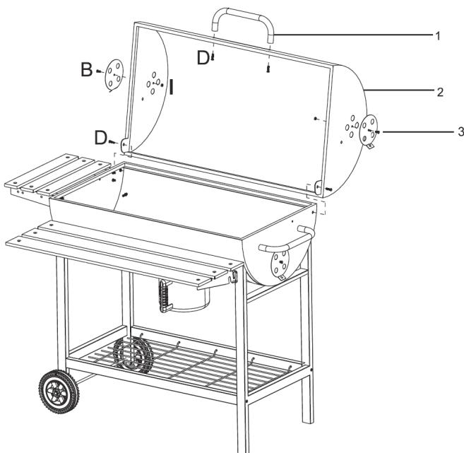
Posizionare il coperchio (2) sulla vasca per la carbonella (6). Allineare il foro filettato sul retro del coperchio con i fori della vasca per la carbonella e fissare il coperchio con 2 viti (D). Fissare le aperture di ventilazione (3) al lato del coperchio con 2 viti (B) e 2 dadi (I). Fissare l'impugnatura (1) con 2 viti (D) al lato anteriore del coperchio.
