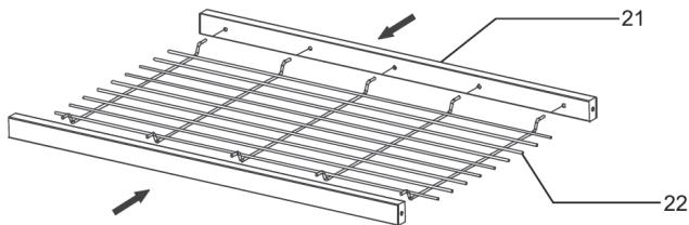
Führen Sie die Enden des Drahtrosts (22) in die passenden Löcher der Metallstrebe (21) ein.
