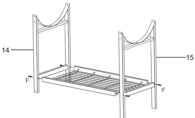
Fixez le pied court (14) avec 2 vis (F) sur un côté du support métallique. Fixez le pied long (15) avec 2 vis (F) de l'autre côté du support métallique (21).
