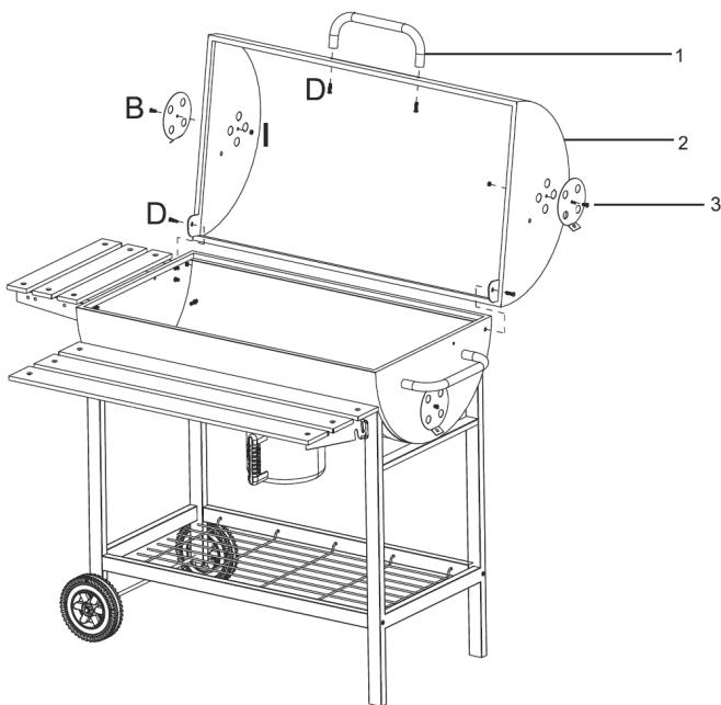
Placez le couvercle (2) sur le foyer (6). Alignez le trou fileté à l'arrière du couvercle avec les trous du foyer et fixez le couvercle avec 2 vis (D). Fixez les ouvertures d'aération (3) sur le côté du foyer avec 2 vis (B) et 2 écrous (I). Fixez la poignée métallique (1) à l'avant du foyer avec deux vis (D).
