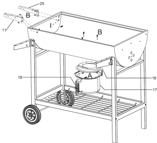
Befestigen Sie das Verbindungsstück des Aschebehälters (16) mit 3 Schrauben (B) und 3 Muttern (I) am Boden der Feuerwanne (6). Befestigen Sie den Bakelitgriff mit 2 Schrauben (A) am Aschebehälter. Befestigen Sie den Aschebehälter am Verbindungsstück. Befestigen Sie die Stütze für die Seitenablage (11 & 25) mit 4 Schrauben (B) und 4 Muttern (I) an der Seite der Feuerwanne.
