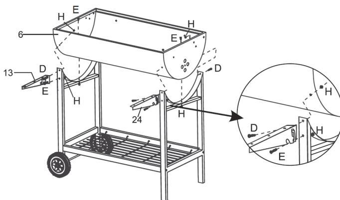
Fixez le foyer (6) et le support de la tablette avant (13 & 24) aux pieds avec 4 vis (D), 4 boulons (E) et 8 écrous M6 (H).
