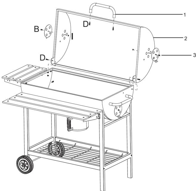
Coloque la tapa (2) en la bandeja de fuego (6). Alinee el orificio roscado de la parte posterior de la tapa con los orificios de la bandeja de fuego y fije la tapa con 2 tornillos (D). Fije los soportes de la repisa lateral (3) al lateral de la bandeja con 2 tornillos (B) y 2 tuercas (I). Fije el asa metálica (1) a la parte delantera de la tapa con 2 tornillos (D).
