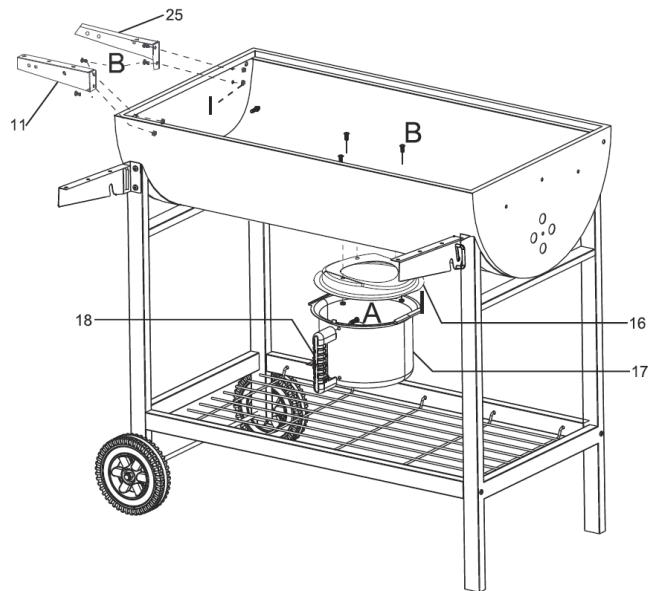
Fixez la pièce de raccordement du bac à cendres (16) au dessous du foyer (6) avec 3 vis (B) et 3 écrous (I). Fixez la poignée en bakélite au bac à cendres à l'aide de 2 vis (A). Attachez le bac à cendres à la pièce de raccordement. Fixez les supports de la tablette latérale (11 & 25) sur le côté du foyer avec 4 vis (B) et 4 écrous (I).
