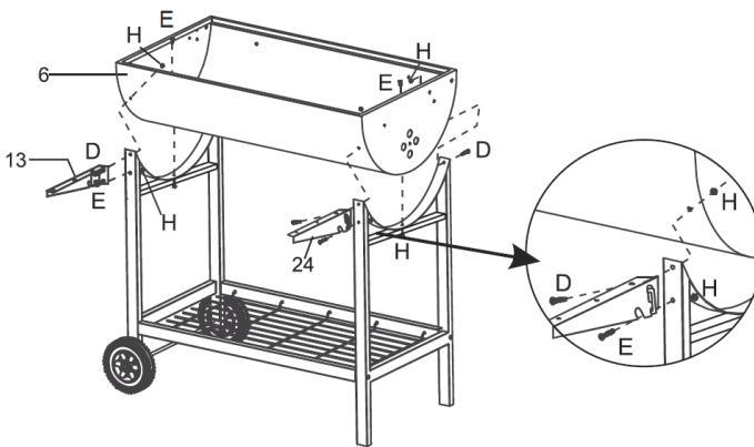
Befestigen Sie die Feuerwanne (6) und die Stütze für die vordere Ablage (13 & 24) mit 4 Schrauben (D), 4 Stück Schrauben (E) und 8 M6-Muttern (H) an den Beinen.
