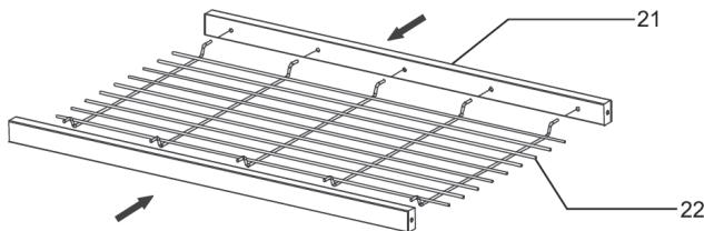
Introduzca los extremos de la rejilla de alambre (22) en los orificios adecuados del puntal metálico (21).
