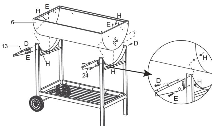
Fije la bandeja (6) y el soporte para el estante delantero (13 & 24) a las patas con 4 tornillos (D), 4 trozos de pernos (E) y 8 tuercas M6 (H).
