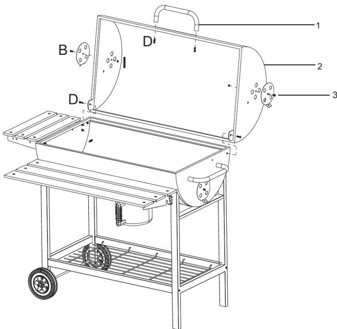
Setzen Sie den Deckel (2) auf die Feuerwanne (6). Richten Sie die Gewindebohrung hinten am Deckel an den Bohrungen der Feuerwanne aus und befestigen Sie den Deckel mit 2 Schrauben (D). Befestigen sie dann die Luftöffnungen (3) mit 2 Schrauben (B) und 2 Muttern (1) an der Seite des Deckels. Befestigen Sie den Metallgriff (1) mit 2 Schrauben (D) an der Vorderseite des Deckels.
