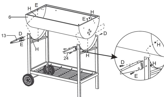
Fissare la vasca per la carbonella (6) e il supporto per il ripiano anteriore (13 & 24) alle gambe con 4 viti (D), 4 viti (E) e 8 dadi M6 (H).
