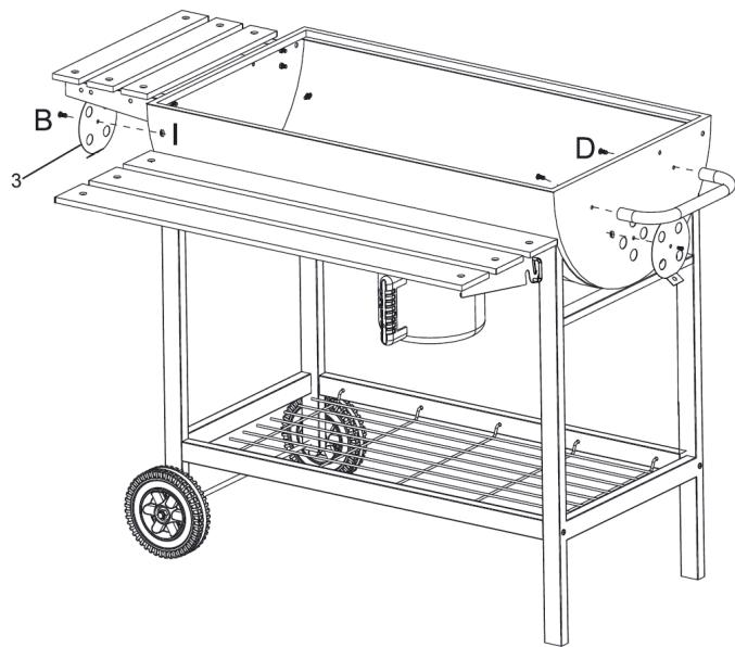
Fixez la poignée (1) sur le côté du foyer avec deux vis (D). Fixez les ouvertures d'air (3) sur le côté du foyer avec 2 vis (B) et 2 écrous (I).
