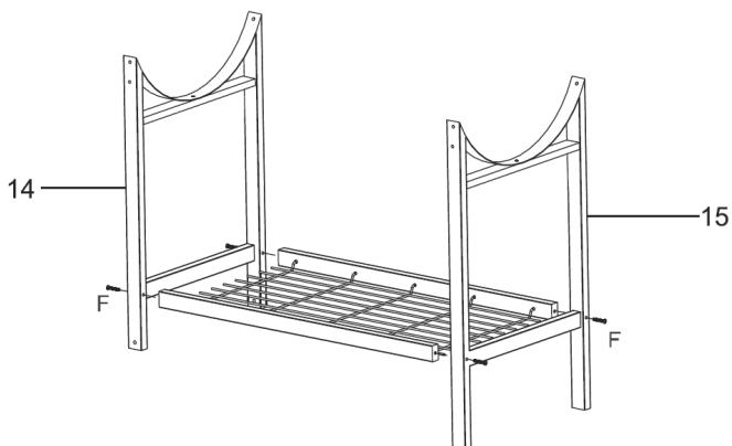
Fije la pata corta (14) con 2 tornillos (F) a un lado del puntal metálico. Fije la pata corta (15) con 2 tornillos (F) a un lado del puntal metálico (21).
