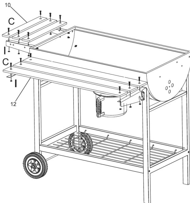
Fije las piezas de madera de la balda delantera (12) al soporte de la balda delantera (13) con 6 tornillos (C) y 6 tuercas (I). Coloque los estantes laterales (10) en los soportes de los laterales (11) y fíjelos con 6 tornillos (C) y 6 tuercas (I).
