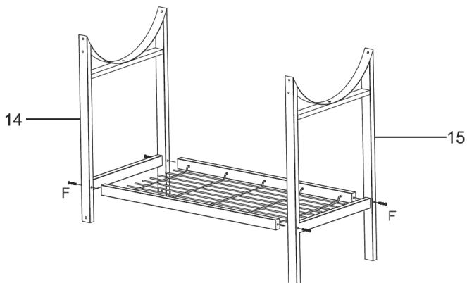
Fissare la gamba corta (14) con 2 viti (F) su un lato del montante metallico.
