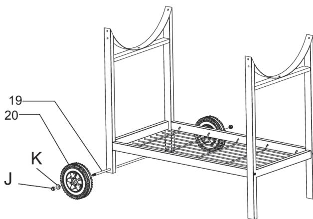
Pase el eje (19) por los agujeros de la pata corta (14) y fije las ruedas (20) a ambos lados del eje. Coloque la arandela (K) en ambos extremos del eje y apriete con 2 tuercas M8 (J).
