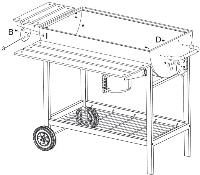
Befestigen Sie den Griff (1) mit 2 Schrauben (D) an der Seite der Feuerwanne. Befestigen Sie die Luftöffnungen (3) mit 2 Schrauben (B) und 2 Muttern (I) an der Seite der Feuerwanne.
