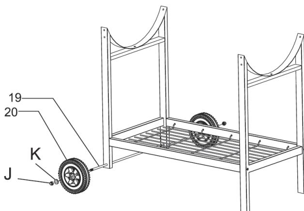
Inserire l'asse (19) attraverso i fori della gamba corta (14) e fissare le ruote (20) su entrambi i lati dell'asse. Fissare la rondella (K) a entrambe le estremità dell'asse e stringere con 2 dadi M8 (J).
