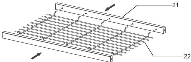
Insérez les extrémités de la grille (22) dans les trous correspondants du support métallique (21).
