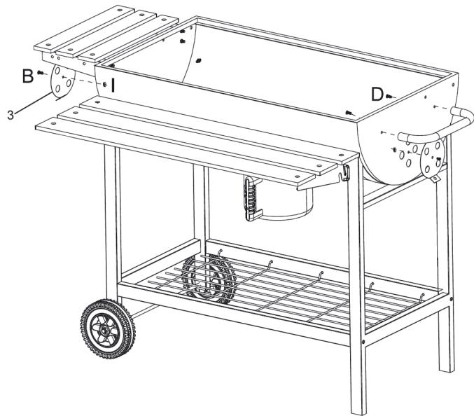
Fije el asa (1) al lateral de la bandeja de fuego con 2 tornillos (D). Fije los soportes de la repisa lateral (3) al lateral de la bandeja con 2 tornillos (B) y 2 tuercas (I).
