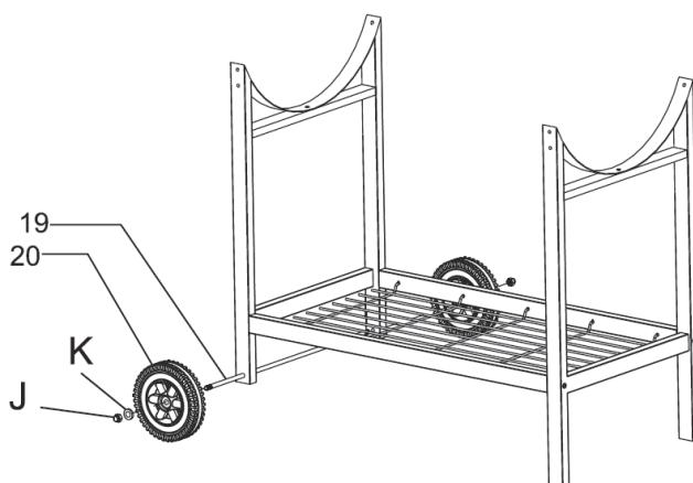
Stecken Sie die Achse (19) durch die Löcher des kurzen Beins (14) und befestigen Sie die Räder (20) an beiden Seiten der Achse. Befestigen Sie die Unterlegscheibe (K) an beiden Enden der Achse und ziehen Sie sie mit 2 M8-Muttern (J) fest.
