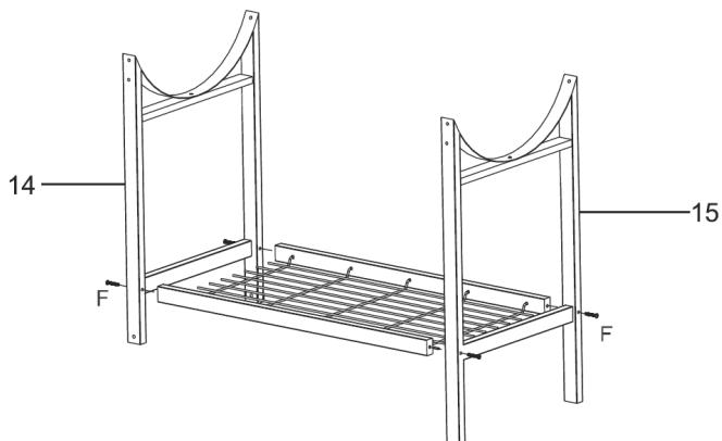
Befestigen Sie das kurze Bein (14) mit 2 Schrauben (F) an einer Seite der Metallstrebe. Befestigen Sie das lange Bein (15) mit 2 Schrauben (F) an der anderen Seite der Metallstrebe (21).
