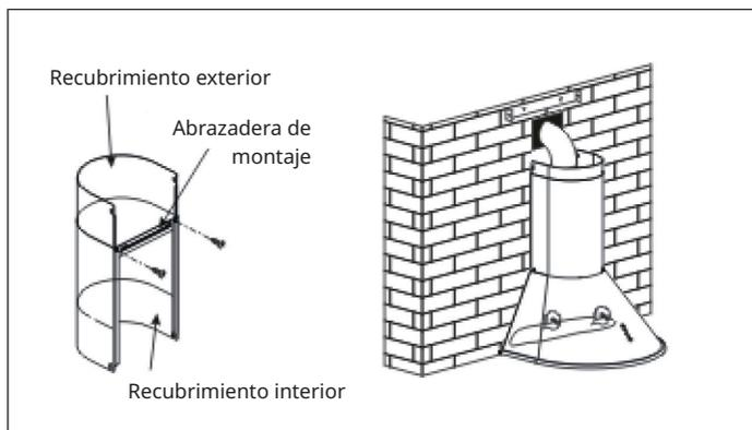
5. Establezca la altura del recubrimiento interior en la posición del soporte interior de la chimenea y fjelo con un tornillo mientras fija el recubrimiento exterior con tornillos a la estructura de la campana extractora. Después de haber establecido la posición, fije la carcasa con un tornillo de seguridad.
