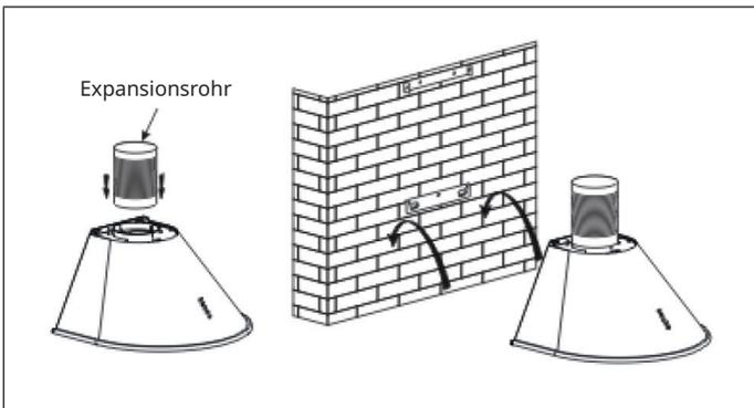
4. Befestigen Sie die äußere Schornsteinhalterung am äußeren Schornstein und achten Sie darauf, dass der innere Schornstein frei in der Höhe verstellbar ist. Montieren Sie anschließend den Schornstein auf der Dunstabzugshaube und heben Sie das Expansionsrohr durch das Loch an der Wand bis aus der Wand.
