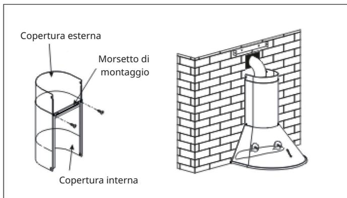
5. Regolare l'altezza della copertura interna sulla posizione del supporto della canna interno e fissarlo con una vite, mentre la copertura esterna viene fissata con le viti al corpo della cappa aspirante.
