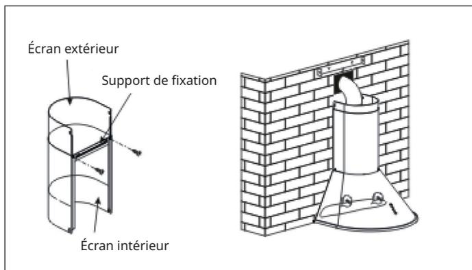
5. Ajustez la hauteur du panneau intérieur à la position du support de cheminée intérieur et fixez-le avec une vis tout en fixant le panneau extérieur au corps de la hotte à l'aide de vis. Après avoir réglé la position, fixer le boîtier à l'aide d'une vis de sécurité.
