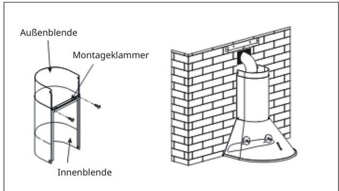
5. Stellen Sie die Höhe der Innenblende auf die Position der inneren Schornsteinhalterung ein und befestigen Sie diese mit einer Schraube, während Sie die Außenblende mit Schrauben am Dunstabzugshaubenkörper befestigen. Nachdem Sie die Position eingestellt haben, befestigen Sie das Gehäuse mit einer Sicherheitsschraube.
