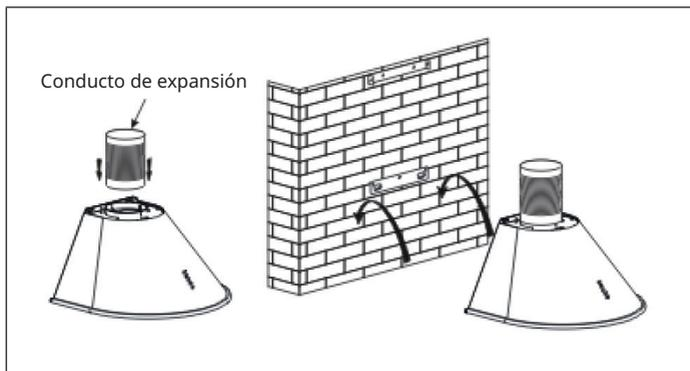
4. Fije el soporte exterior de la chimenea en la chimenea exterior y asegúrese de que se pueda regular la altura de esta. Monte a continuación la chimenea sobre la campana extractora y levante el conducto de expansión por el orificio de la pared hasta la pared.
