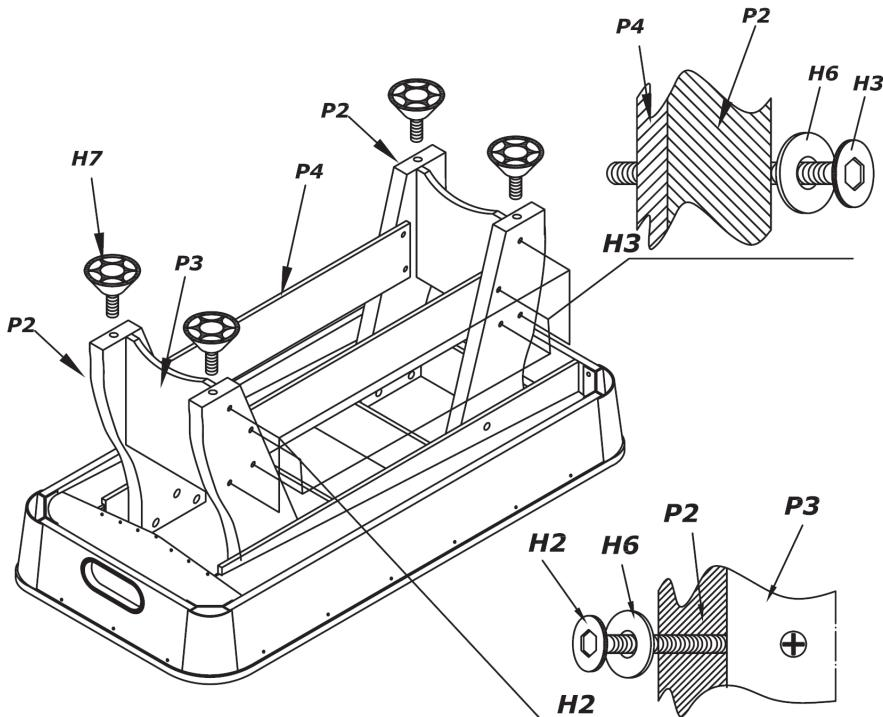
1. Montieren Sie die beiden Endplatten (P3) an die Innenseite der Beine. Benutzen Sie hierfür die ¼"-Zoll-Schrauben (H2) sowie die Unterlegscheiben H6. (Die Gewinde sind bereits in die Beinstücke eingearbeitet).
