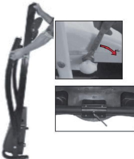
A questo punto, fissare il corrimano al telaio e fissarlo con la chiave a brugola. Eseguire il collegamento dei contatti sulla barra destra del telaio. Quindi applicare la copertura di plastica.
