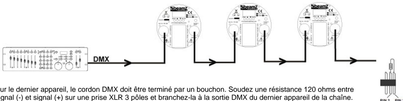
Sur le dernier appareil, le cordon DMX doit être terminé par un bouchon. Soudez une résistance 120 ohms entre signal (-) et signal (+) sur une prise XLR 3 pôles et branchez-la à la sortie DMX du dernier appareil de la chaîne.
